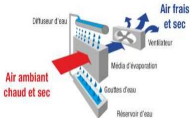
Figure I.6: Illustration du refroidisseur par évaporation [69]
