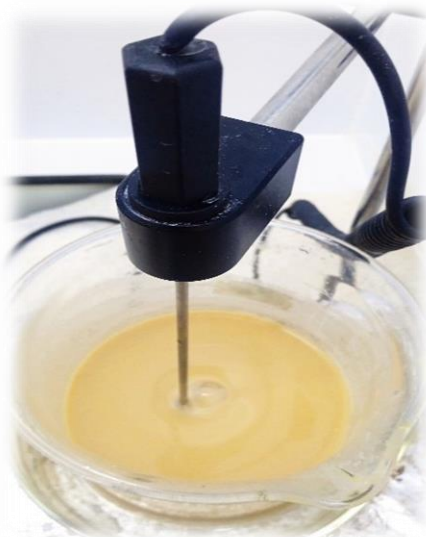
Figure II.05: Traitement par acide (HCl à 85°C).
