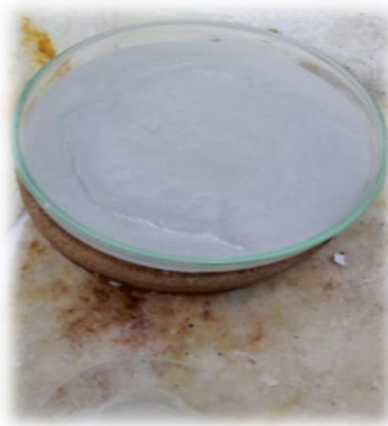
Figure II.18 : mise en moule du mélange.
