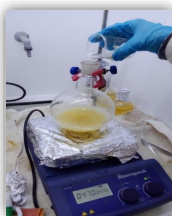
Figure II.12 : L'ajout du mélange acétylant (anhydride acétique et acide acétique).
