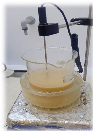
Figure II.04: Trempage de bois dans l'eau chaude
