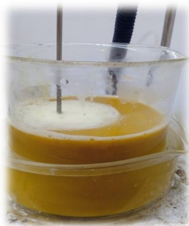
Figure II.06 : Traitement alcaline par NaOH.
