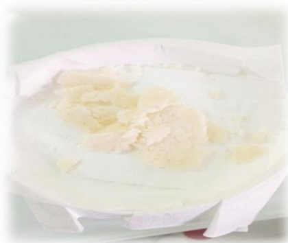
Figure II.07: cellulose extraite et séchée.
