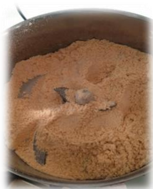
Figure II.02 : Broyage de sciure de bois.
