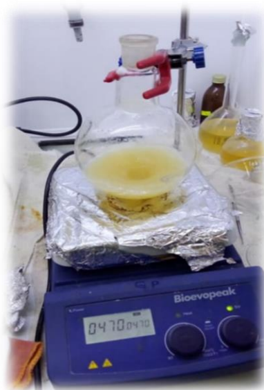
Figure II.11 : Solution de l'acide acétique et la cellulose.
