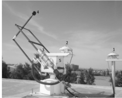
Figure 1.3: Station radiométrique pour mesurer l'irradiance solaire globale, directe et diffuse : (1) Pyranomètre pour mesurer l'irradiance solaire globale. (2) Pyranomètre pour mesurer la diffusion. (3) Pyrhélio pour mesurer l'irradiance solaire directe, (4) Pyranomètre ombragé. (5) Le suiveur solaire à 2 axes
