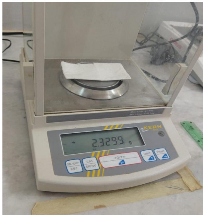
Figure II.6 : Balance de précision (KERN ABJ, d=0.0001g) utilisée pour la pesée individuelle des papiers de soie (Photo de l'auteur).
