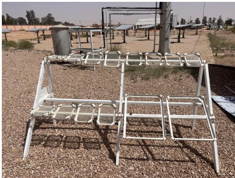
Figure II.2 : Vue générale du support expérimental utilisé pour l'exposition des échantillons de verre au site de l'URAER (Photo de l'auteur)
