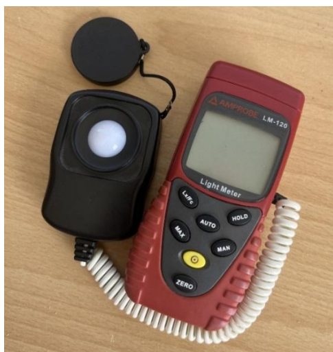
Figure II.5 : Luxmètre numérique (Amprobe LM-120 light Mètre) utilisé pour la mesure quotidienne de la transmissivité lumineuse (Photo de l'auteur).
