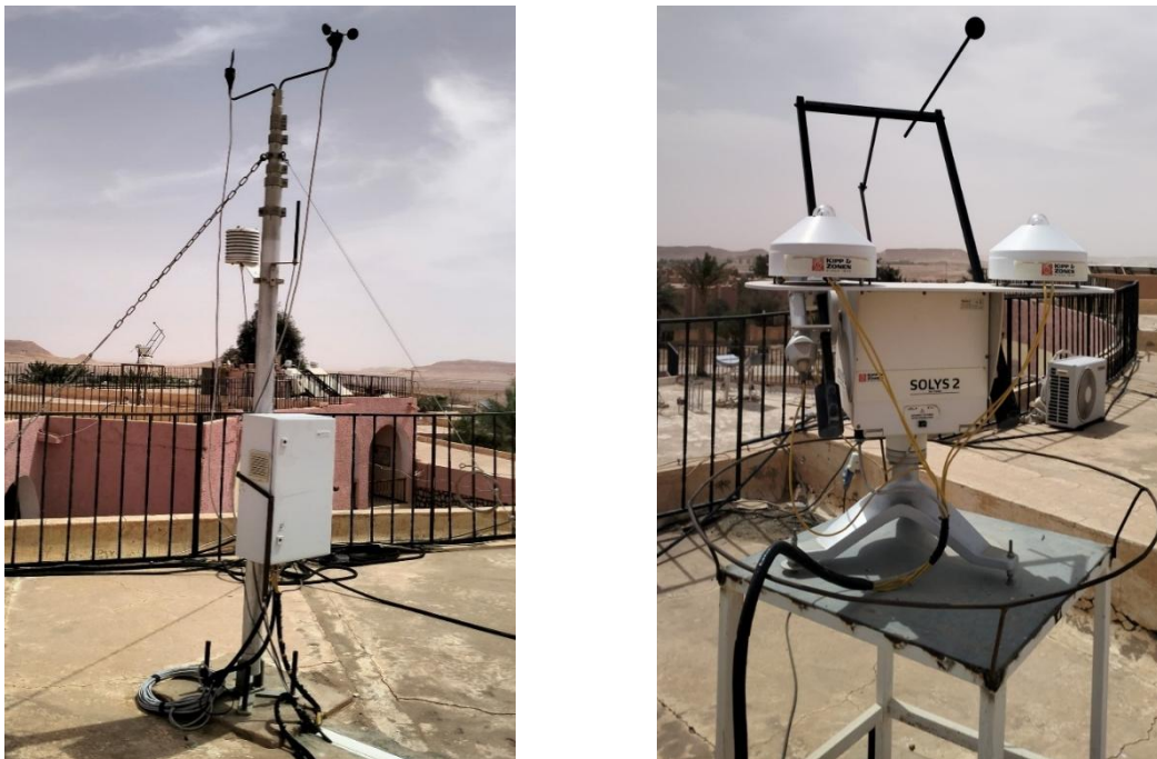
Figure II.7 : Anémomètre à ultrasons (Modèle Vaisala WXT530) de la station météorologique de l'URAER-CDER (Photo de l'auteur).
