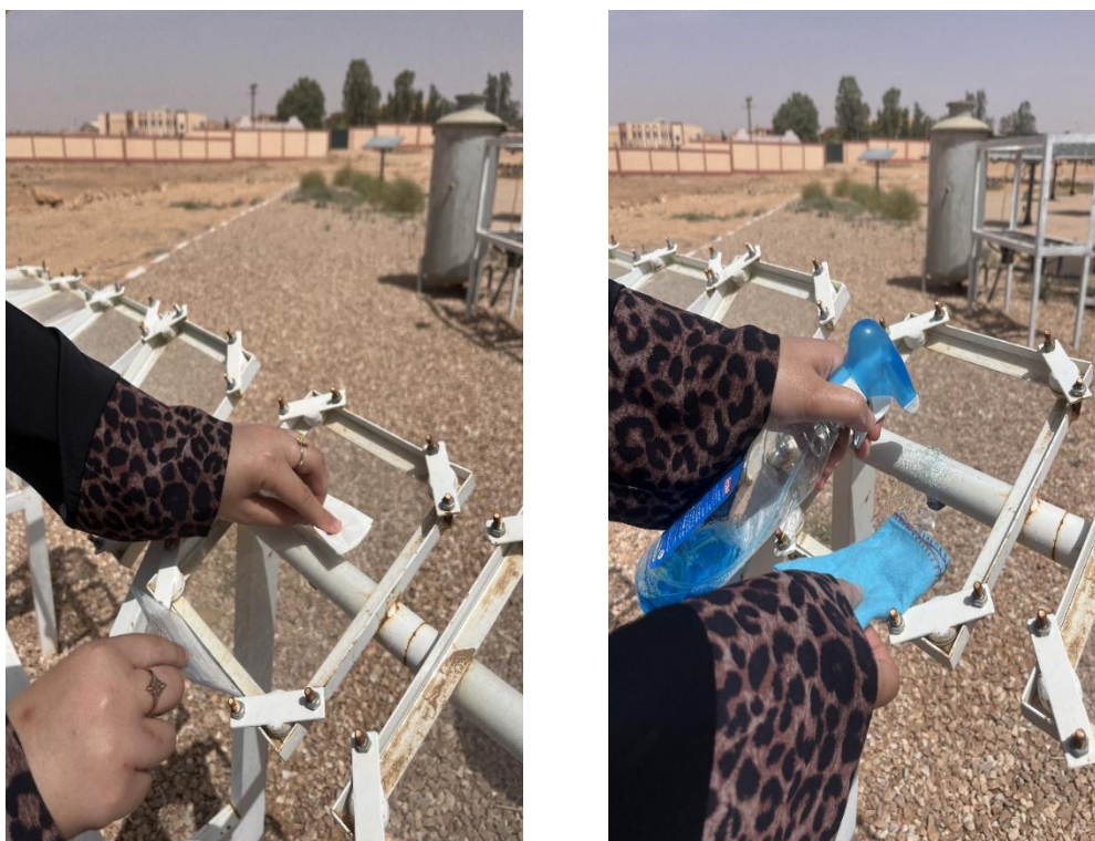
Figure II.4 : Processus de collecte de la poussière à l'aide d'un papier de soie (Photo de l'auteur).
