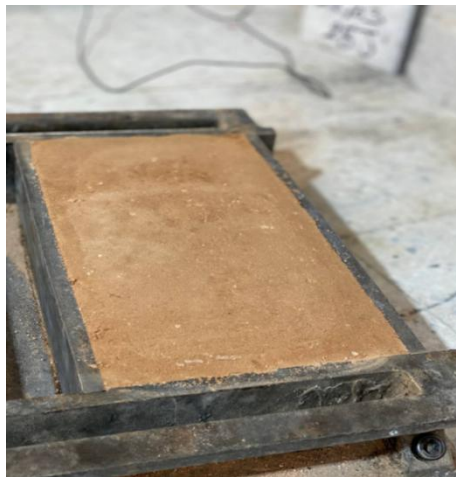
Figure 2.17 : Compactage du mélange dans le moule.
