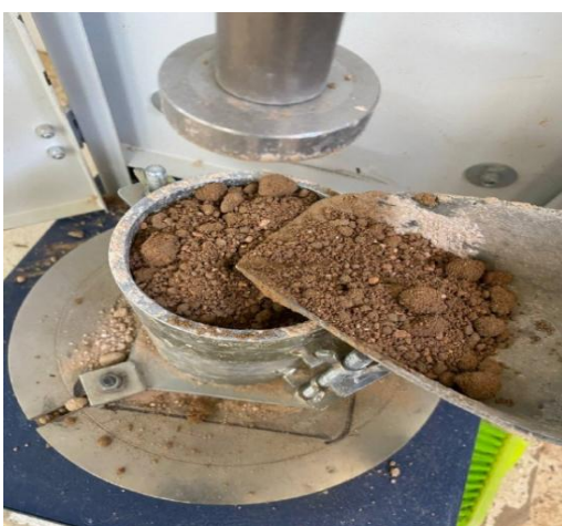
E : compactage du mélange dans le moule
