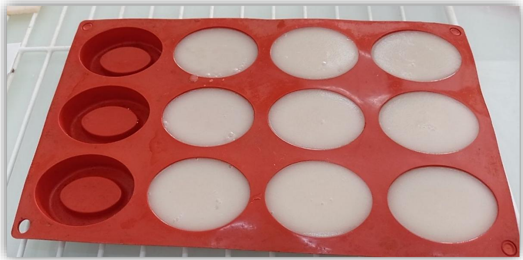
Figure II-7 : Pâte de savon dans des moules en silicone
