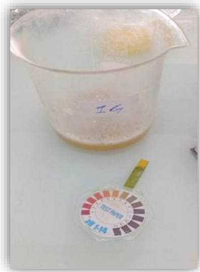
Figure II-14 : Mesure du pH de shampoing 1G
