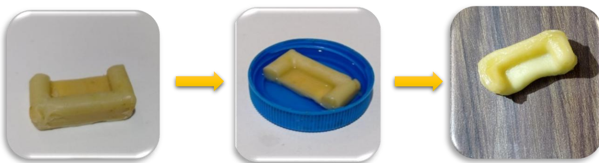
Figure II-8: Formation Savon HO Avant et après test Ramollissement.
