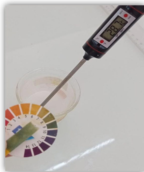
Figure III-2: Mesure du pH à température ambiante
