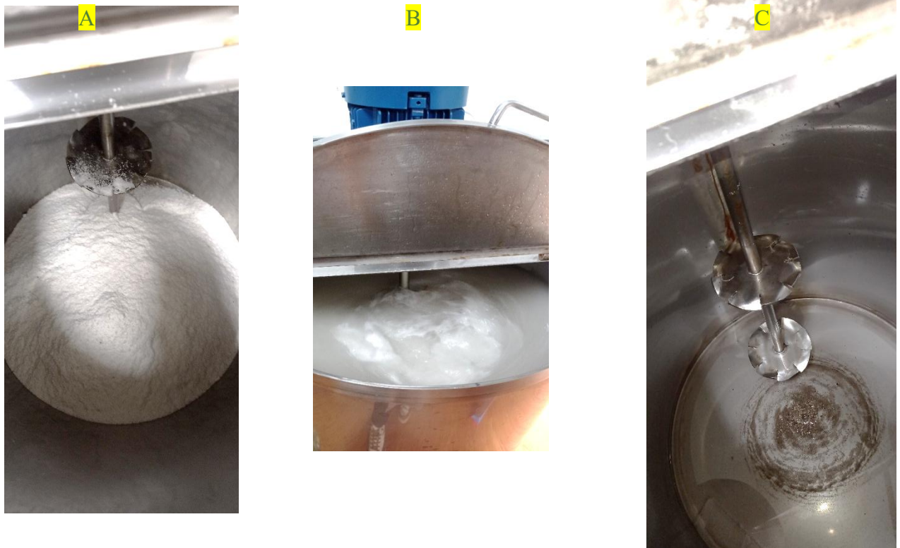
Figure II-12: Étapes de la préparation d'une solution saline (original)
