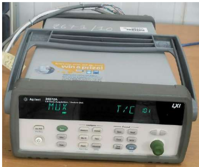
Figure II.8: Unité d'acquisition de donnée de type Agilent 34972A.
