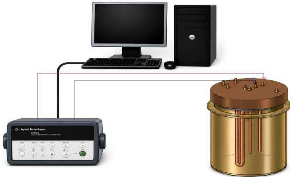
Figure II.9: La chaîne d'acquisition de donnée.
