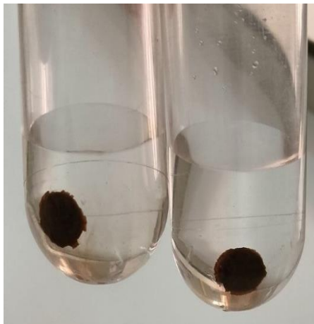
Figure 4. Pellets de nanoparticules d'argent obtenus après centrifugation et purification.
