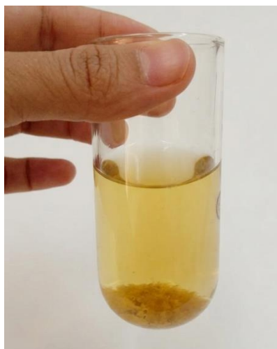
Figure 3. Séparation du surnageant et du culot par centrifugation de la culture
