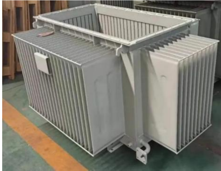
Figure I.25: cuve d'un transformateur
