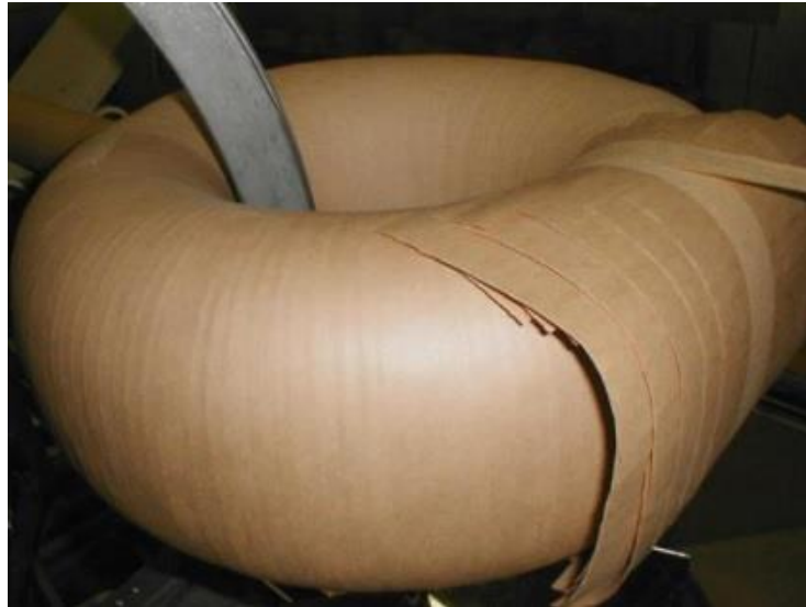
Figure III.1 : Isolation cellulosique autour du noyau magnétique [24]
