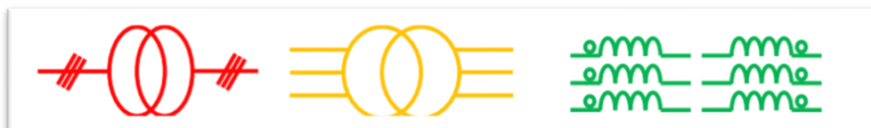
Figure I.11 : Symboles d'un transformateur triphasé [7]
