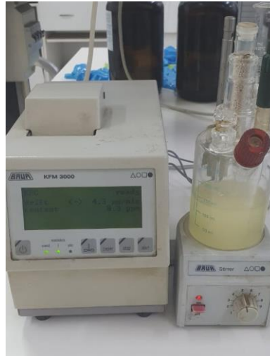
Figure III.6 : mesure de la teneur en eau (titrateur KFM 300)
