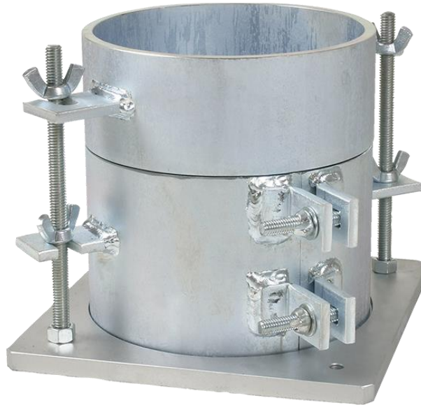
Figure 1.4 : Moule à proctor modifié [6]
