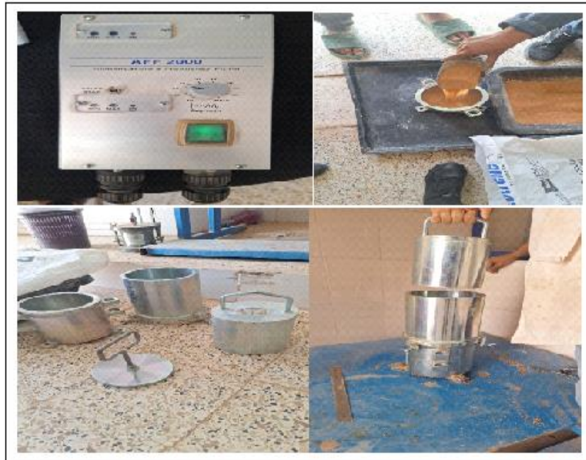
Figure 3.14: Essais Table de vibration
