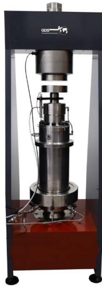
Figure 1.6 : Équipement d'essai de charge statique du sol [22].
