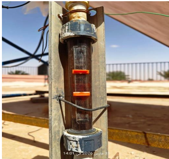
Figure 1-11 : Débitmètre pour eau.
