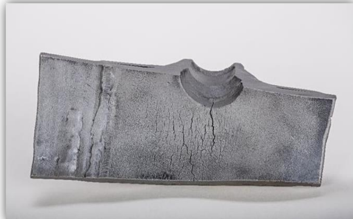
Figure I-11 : Corrosion sous contrainte (CSC)
