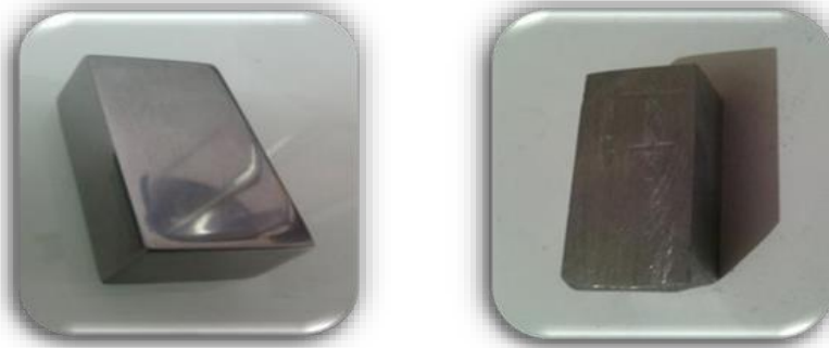
Figure IV-6 : L'échantillon avant et après le polissage
