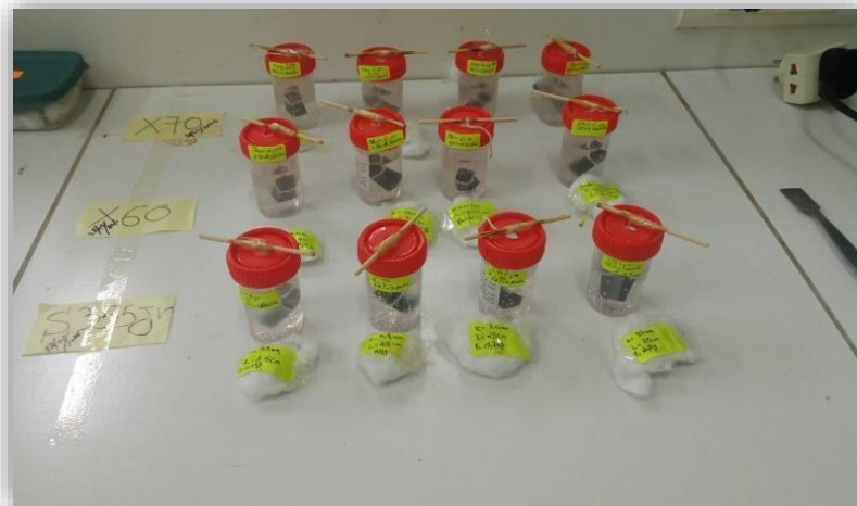
Figure IV-8 : Les essais de la perte de masse.
