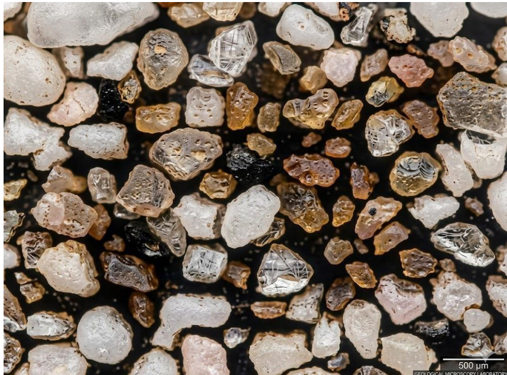
Figure I-3 : Vue générale (à grande échelle, MEB.) du sable de dune.
