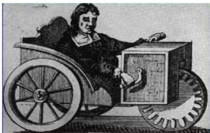
Fig. I.3: Chaise roulante à manivelles de Farfler en 1655
