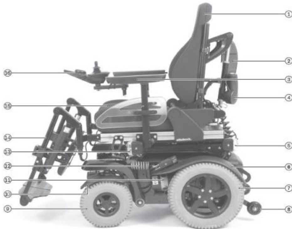
Fig I.18 : Description d'une chaise roulante de type Ottobock b400
