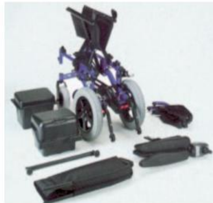
Fig.20: CRE à châssis pliant démonté
