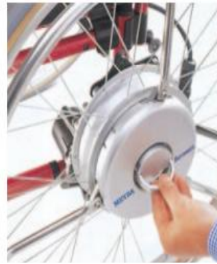
Fig.23: Roue arrière avec motorisation d'assistance électrique
