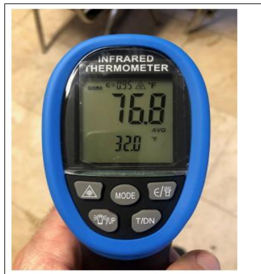
Figure 19 : Thermomètre infrarouge utilisé pour les relevés de température de surface
