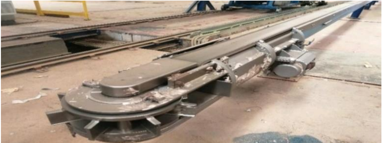
Figure I. 9 : La lance et Turbine de grenailage
