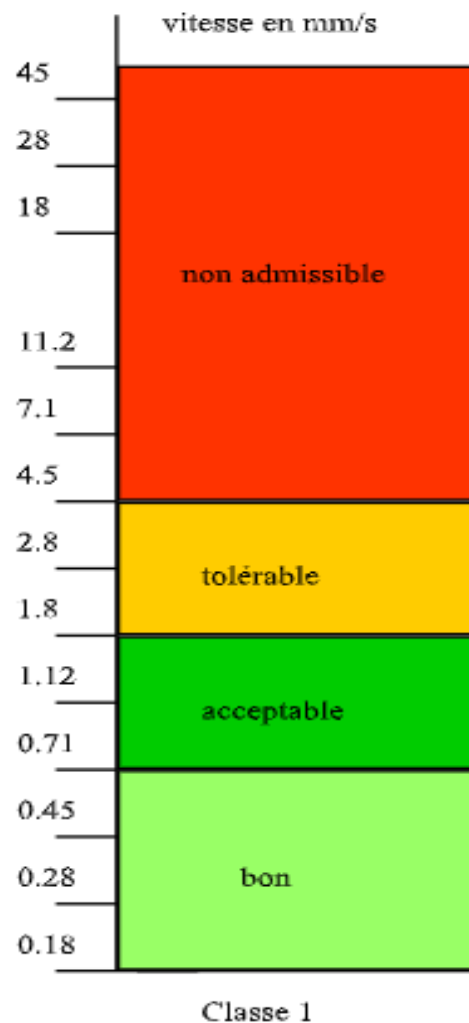
Figure III. 23 : Niveaux vibratoires (la norme ISO 10816)
