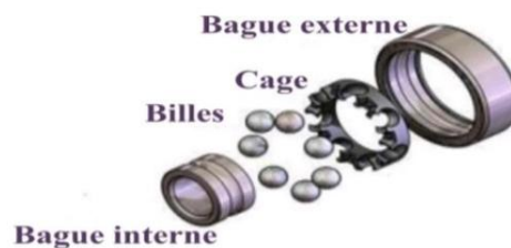
Figure III. 14 : Principaux éléments constitutifs d'un roulement. [23]
