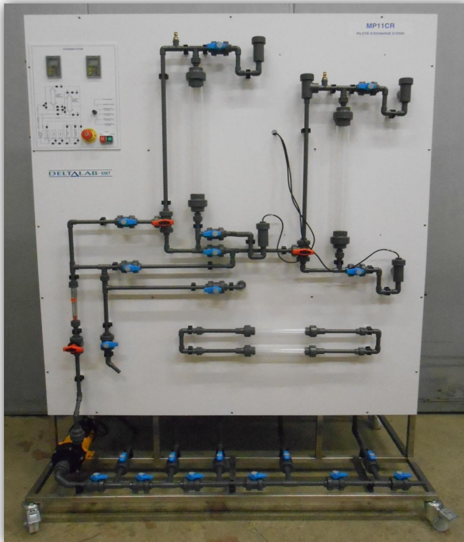
Figure III.32 Pilote d'échange d'ion (traitement de l'eau)
