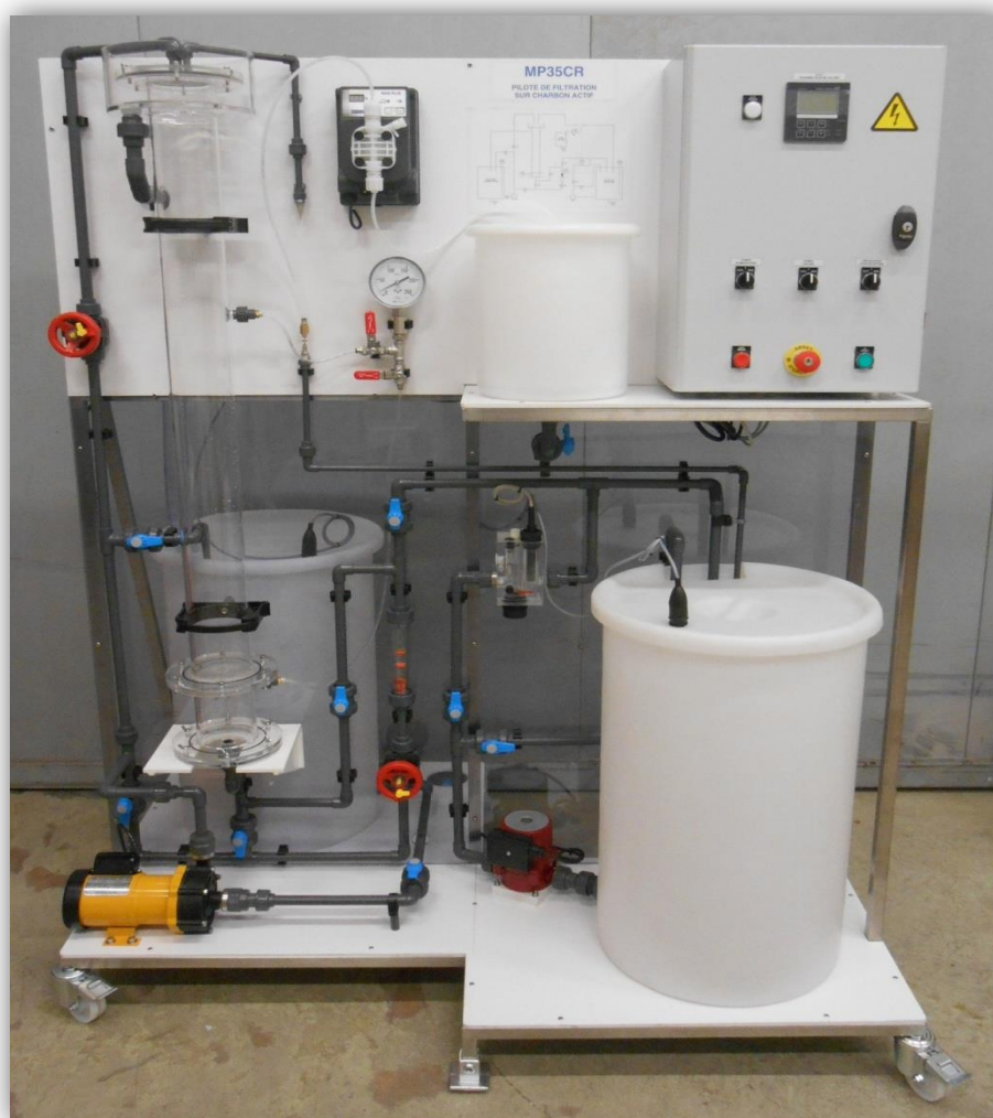
Figure III.29 Pilote de filtration sur charbon Actif
