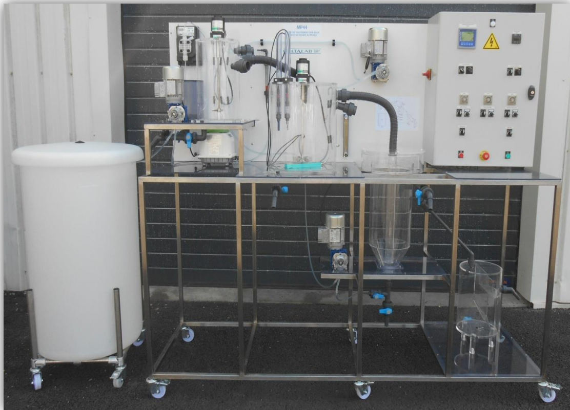
Figure III.30 Pilote de traitement des eaux usée par boues activée
