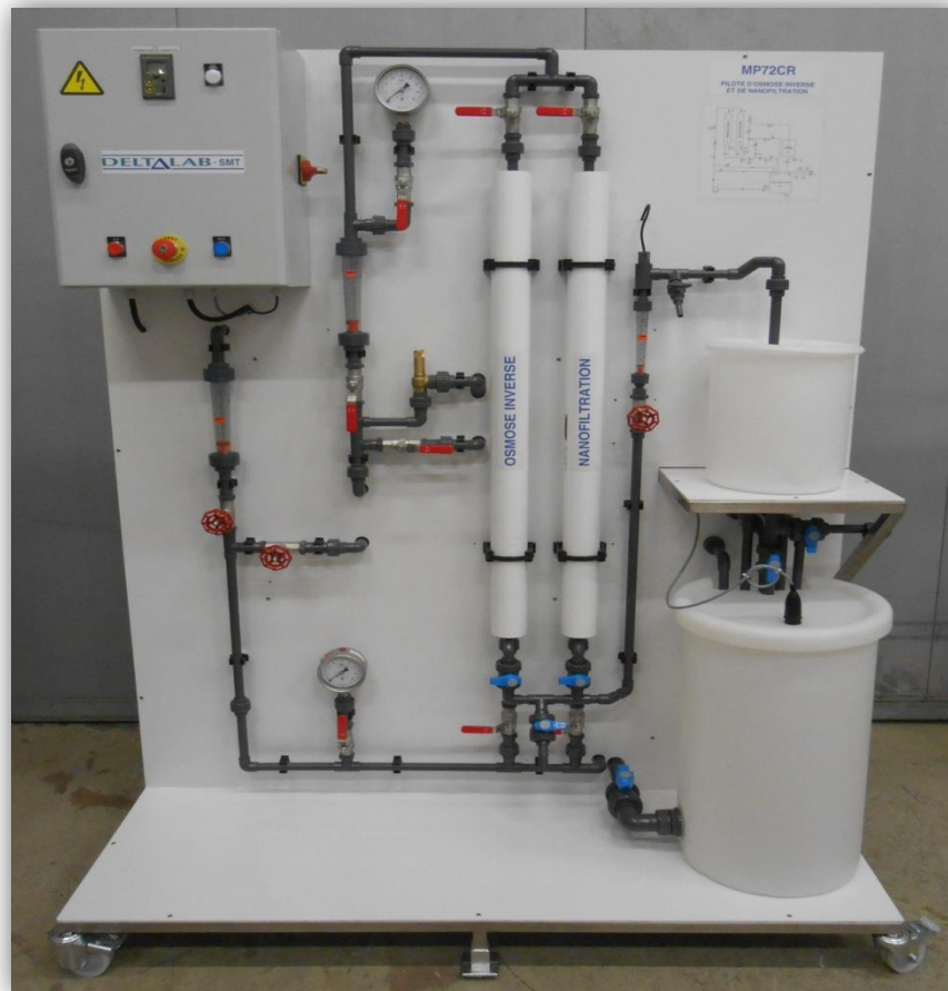
Figure III.31 Pilote d'osmose inverse et de nano-filtration
