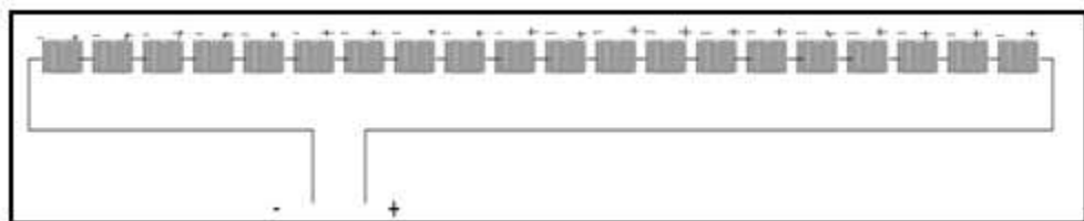
Figure 48 : illustration Générateur photovoltaïque avec configuration 21 panneaux.
