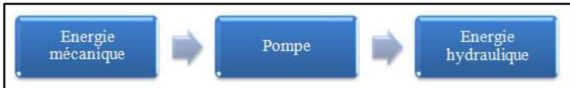
Figure 03 : Principe de conversion d'une pompe hydraulique
