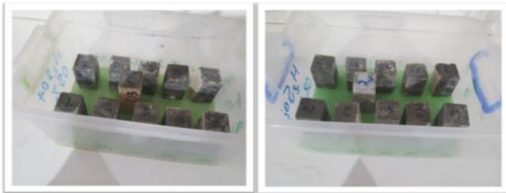
Fig. (III.20): Échantillons du mortier avant l'immerge dans les solutions acides.
