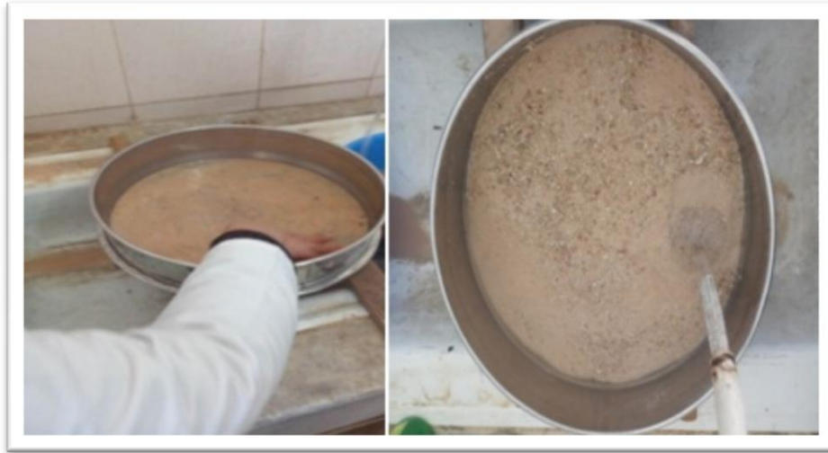
Fig. (III.2): Lavage du sable.
