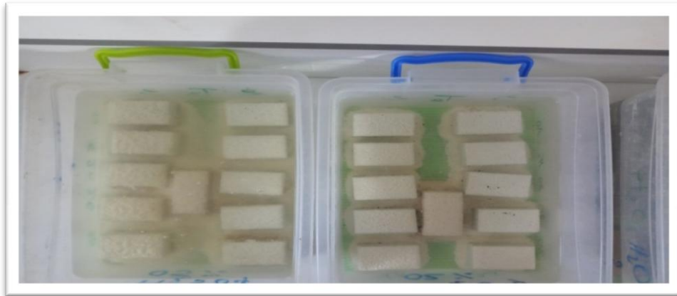
Fig. (III.22): Échantillons du mortier avant l'immersion dans les solutions acides.
