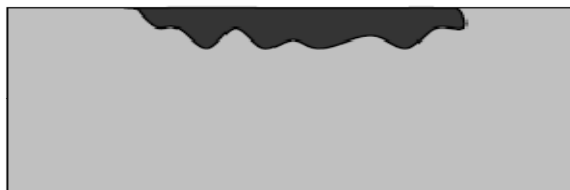
Figure (I.6) : Corrosion érosion
