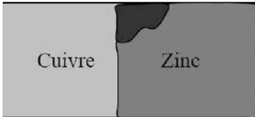
Figure (I.4) : Corrosion galvanique
