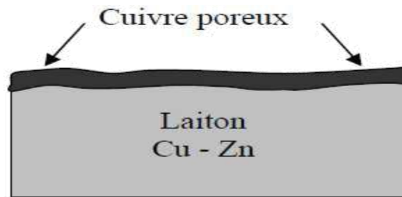
Figure (I.5) : Corrosion sélective
