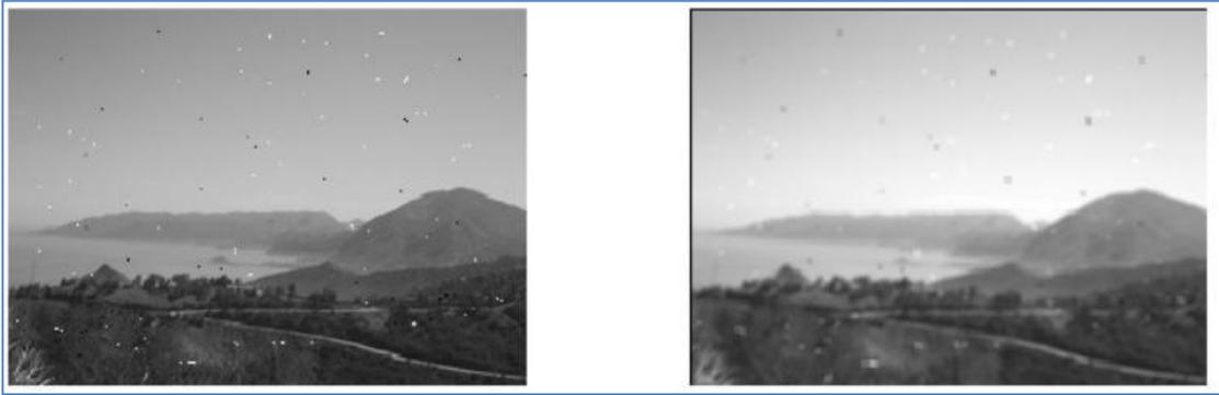
**Figure I.16** : Application d'un filtre moyennneur à une image bruitée [29].
