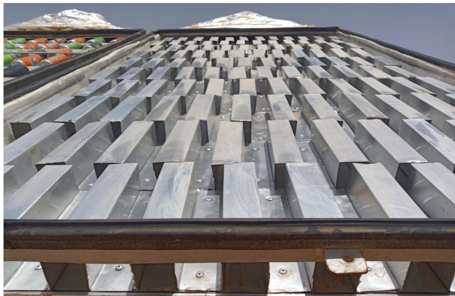
Fig.III.3. capteur solaire avec chicanes
