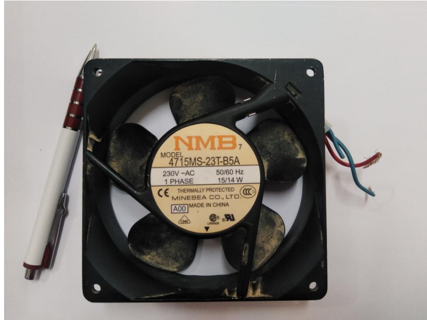
FigIII.15.ventilateur utilisé pour aspirer l'air du capteur solaire vers chambre de séchage
