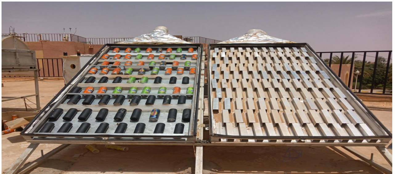
FigIII.6 capteurs solaires avec cannetes et avec chicanes
