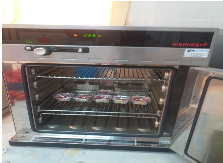
FigIII.20 Photographies du l'Etuve utiliser pour déterminer la teneur en matière sèche
