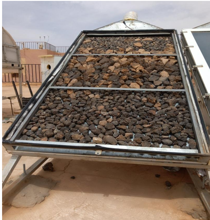
FigIII.4 capteur solaire avec roches
