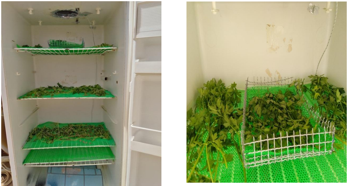
FigIII. 7. Photographe d'une armoire de séchage (frigo)
