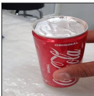
FigIII.36 : Matériau préparé pour le stockage de l'énergie thermique remplissage des cannettes par chlorure de calcium( \text{CaCl}_2,6\text{H}_2\text{O} )
