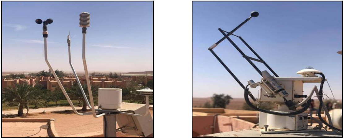
FigIII.13. Photographie des Appareillages de mesures de rayonnement, température et d'humidité relative de l'air ambiant
