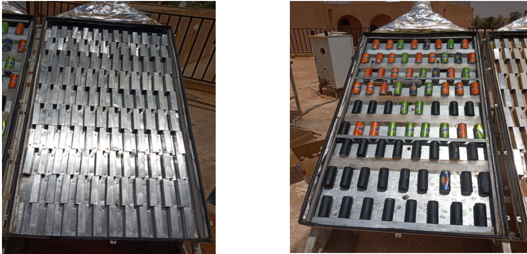
Fig IV.7 : prototypes de séchoir solaire de type indirect sans chicanes (gauche) et avec chicanes (droite).
