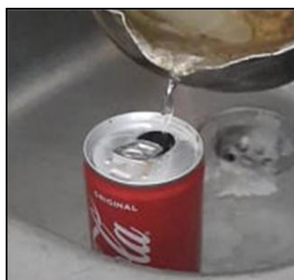
FigIII.36 : Matériau préparé pour le stockage de l'énergie thermique remplissage des cannettes par chlorure de calcium( \text{CaCl}_2,6\text{H}_2\text{O} )
