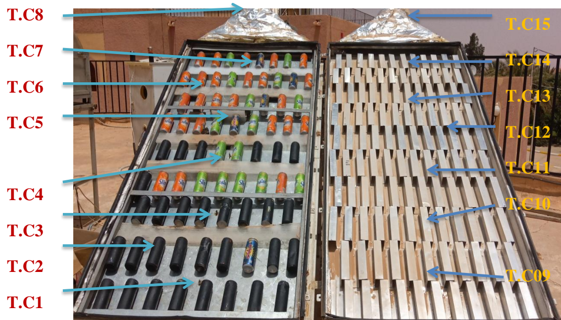
FigIII.12.Position des thermocouples dans les séchoirs solaires
