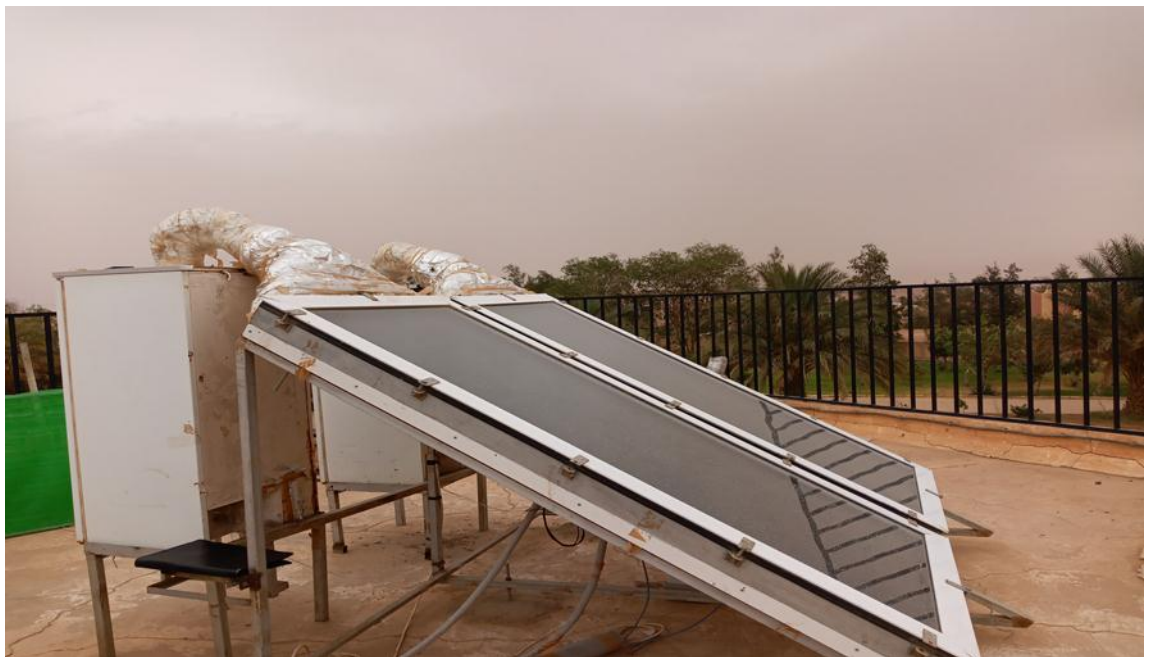
FigIII. 8. les séchoirs solaires de type indirect expérimentés
