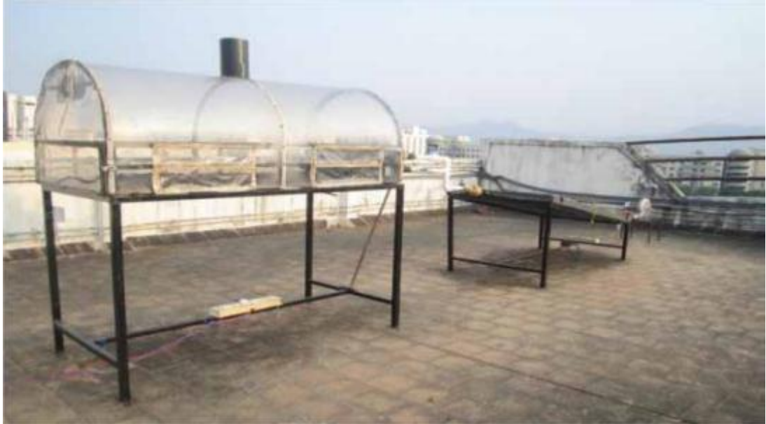
Fig .1.18. Schéma de principe du séchoir tunnel solaire intégré au réchauffeur d'air solaire[14].
