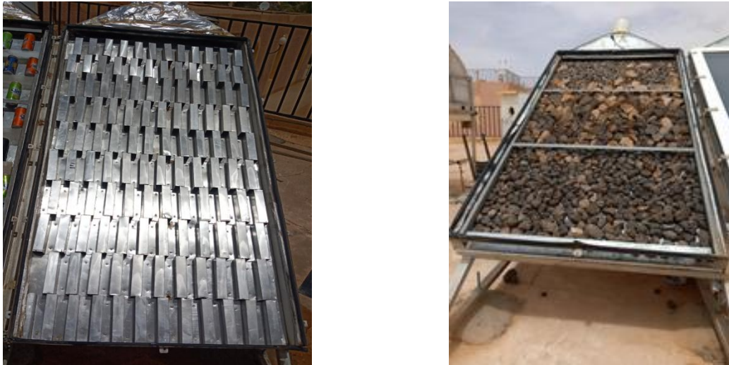
Fig IV.4 : prototypes de séchoir solaire de type indirect sans chicanes (gauche) et avec chicanes (droite).
