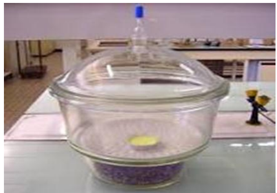
FigIII.19. Photographies de dessiccateur utilisés pour déterminer la teneur en eau initiale
