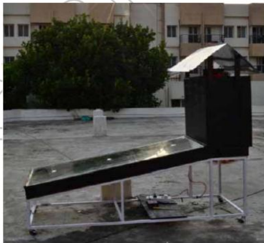
Fig .1.15. Configuration du sécheur solaire[14]
