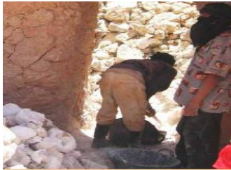
Figure 53 : présente la sortie du four des morceaux de pierre de chaux vive [29]
