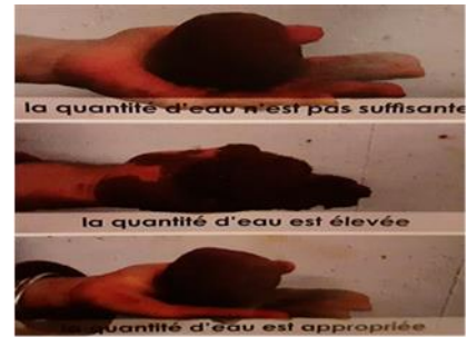
Figure 43 : préparation de terre avec l'eau [28]
