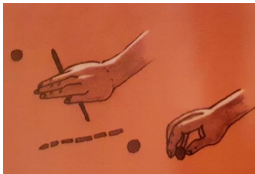
Figure42 : test de consistance [28]
