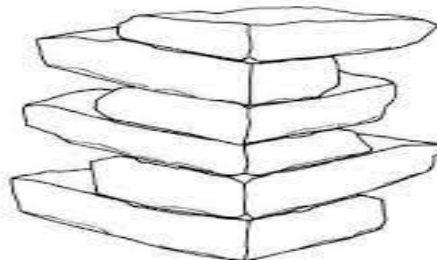
Chaîne d'angle en besace : les éléments en paneressé sur un pan sont en boutisse dans l'autre.
