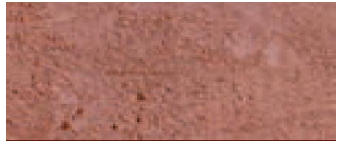
Figure 121 : Traitement de la surface à l'aide d'un régime de datte
