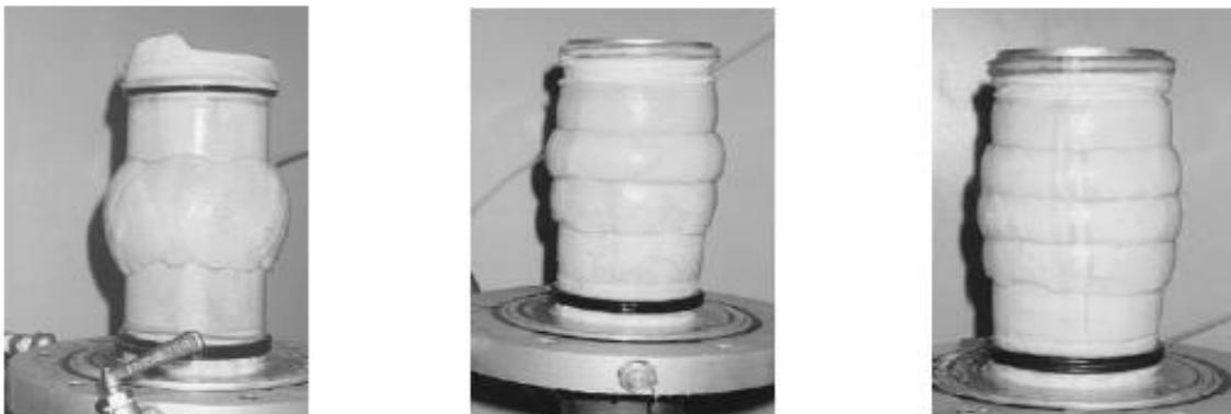
**Figure II.10** : Photos d'échantillons cisailés (Haeri et al., 2000).
