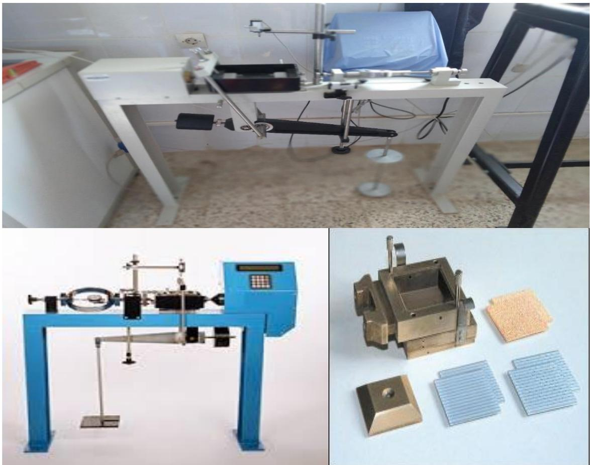
**Photo.VI. 2** : La machine De cisaillement.
