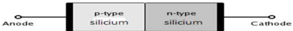
Figure I.10 : Jonction p-n dans du silicium. Sur ce schéma, les régions p et n sont reliées à des contacts métalliques, ce qui suffit à transformer la jonction en diode [13].
