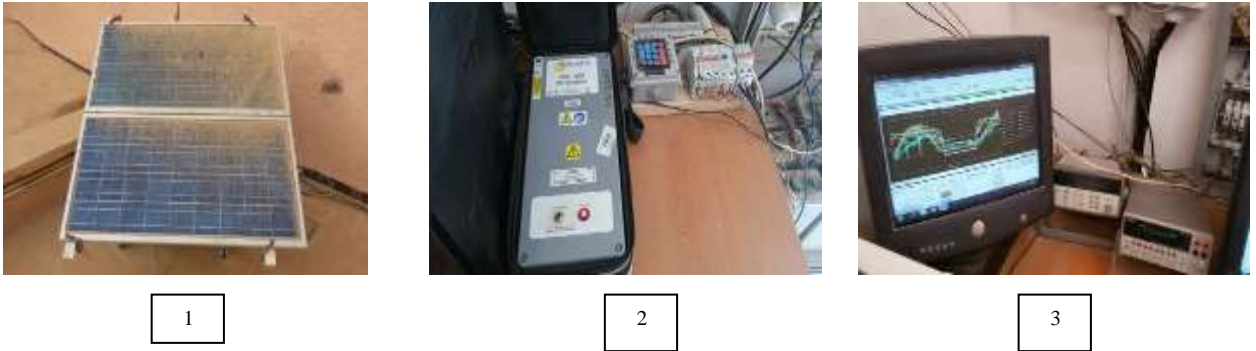
Figure III.1 : Banc d'essais (URAER) : (1) modules PV, (2) Charge électronique (Solmetric I-V Curve Tracer), (3) centrale d'acquisition (Agilent 34970A) et PC.
