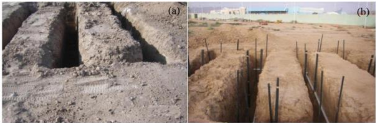
Figure. II. 12. Photos de l'installation expérimentale d'EAHE à l'Université de Biskra, a) trou de forme serpentine; b) PVC horizontal enterré tuyau avec thermocouples. [16]
