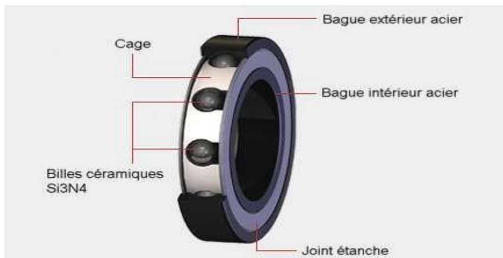
Figure N° 12 : Structure d'un roulement à billes
