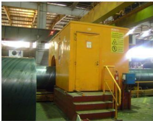
Photo N° 8 : Contrôle de la soudure par radioscopie
