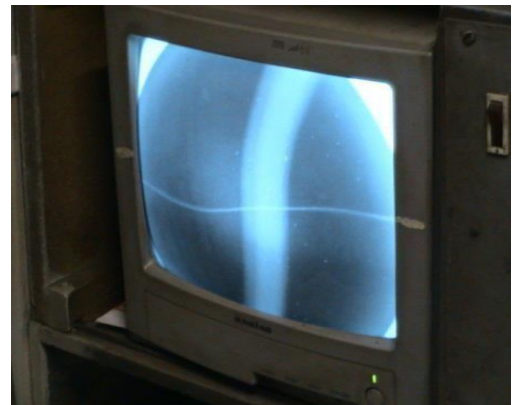
Photo N° 8 : Contrôle de la soudure par radioscopie
