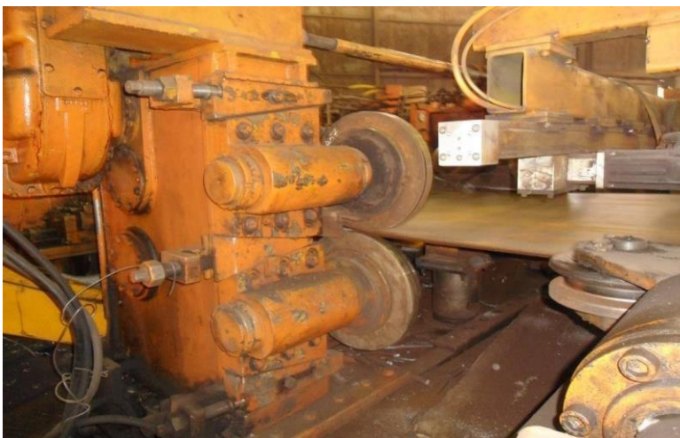
Photo N°4 : Couper les languette de fin de bande
