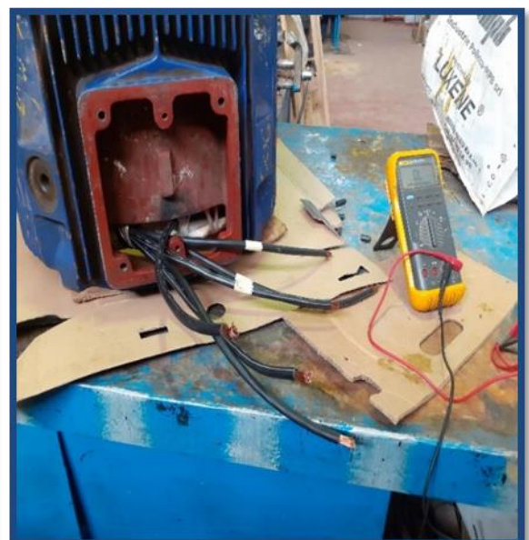
Photo N° 27 : Vérifiant l'ampérage et isolement et résistance par multimètre
