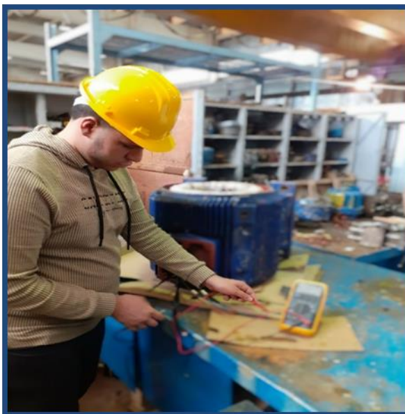
Photo N° 27 : Vérifiant l'ampérage et isolement et résistance par multimètre
