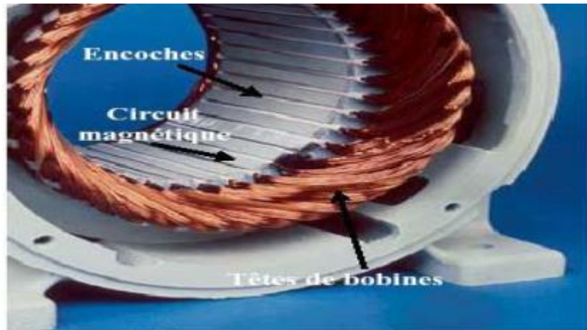
Figure N° 9 : Stator d'un moteur asynchrone
