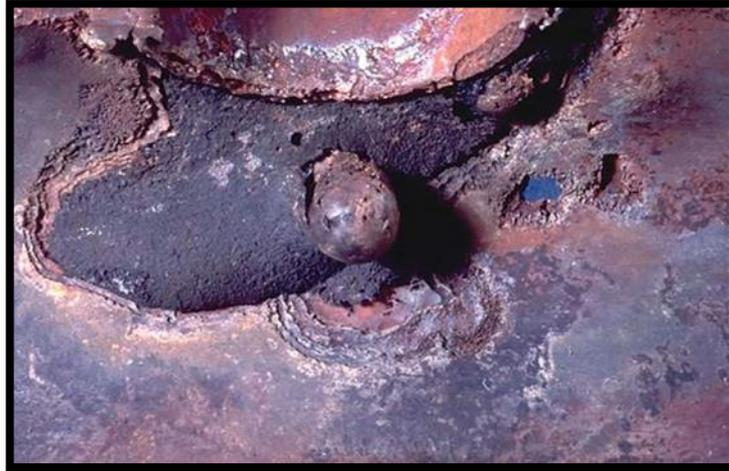
**Figure05:** corrosion galvanique [8].
