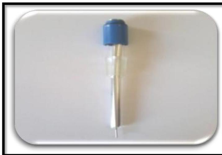
**Figure05:** Electrode d'auxiliaire travail [12].
