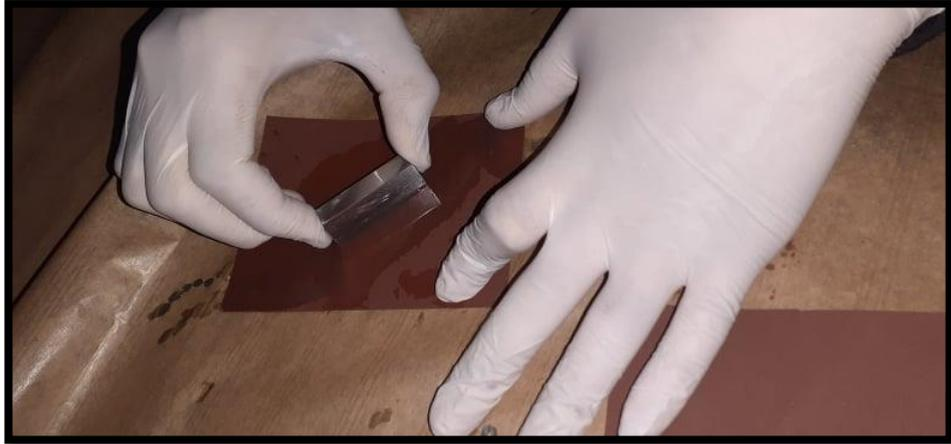
**Photo 17:** Polissage manuelle d'acier X70.
