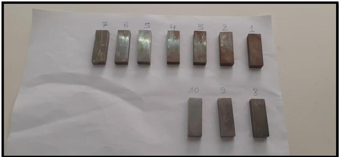
**Photo 21:** L'échantillon avec l'inhibiteur (après 20min d'immersion).
