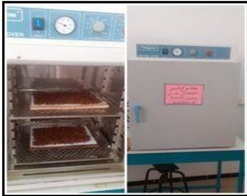
**Photo 06:** séchage artificiel d'échantillon dans l'étuve.
