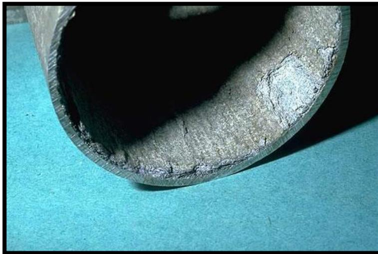
**Figure10:** Corrosion inter granulaire dans un tube d'aluminium [8].
