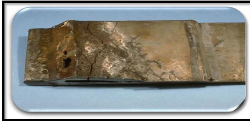
**Figure09:** Corrosion sous contrainte d'un assemblage en acier allié soudé (contraintes liées au soudage) [8].
