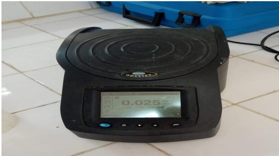
Figure III. 7.Spectrophotomètre UV/VIS.
