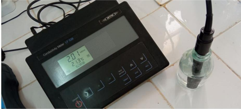
Figure III. 2. Conductimètre.
