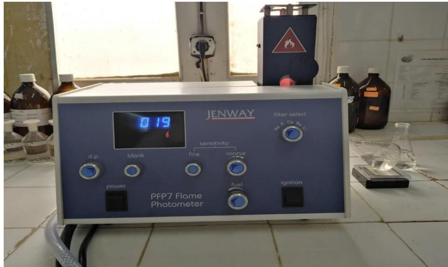
Figure III. 9. Photomètre de flamme.
