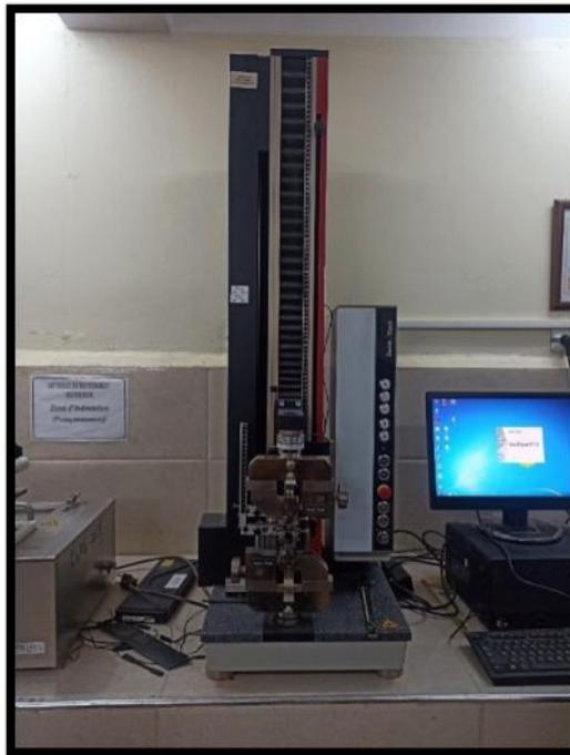
**Figure II.5.** Machine de l'essai de traction **ZWICK / ROELL**.
