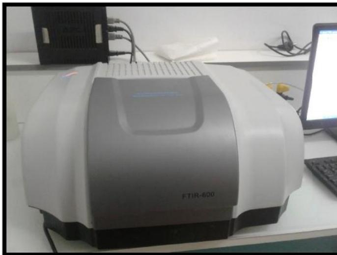
**Figure II.3.** Spectroscopie Infrarouge à Transformer de Fourier (FT-IR).
