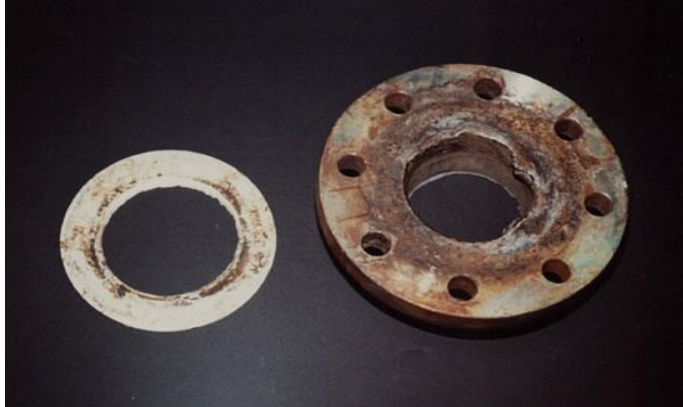
Figure II-3 : Corrosion caverneuse d'un acier allié sous un joint [12]
