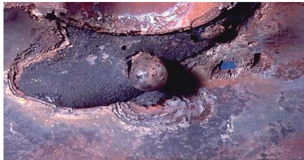
Figure II-4: Corrosion galvanique au niveau d'une zone de brasage entre la brasure Cu-P et le tube en cuivre [13]
