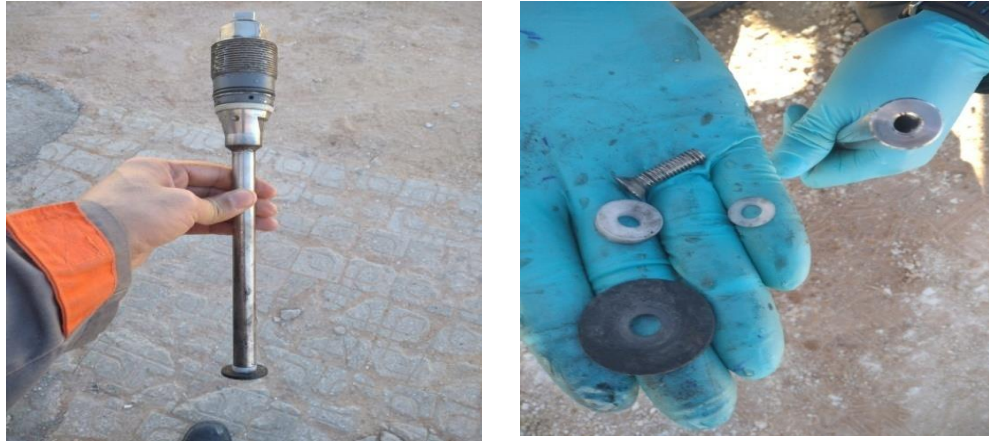
PhotoIII-5 : Un coupon rondelle utilisé sur le pipeline vers CPF
