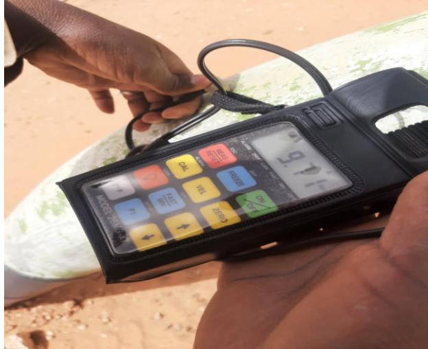
Photo III-4 : Appareil ultrason pour la mesure d'épaisseur
