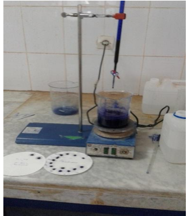
Photo N°(7): Essai bleu de méthylène
