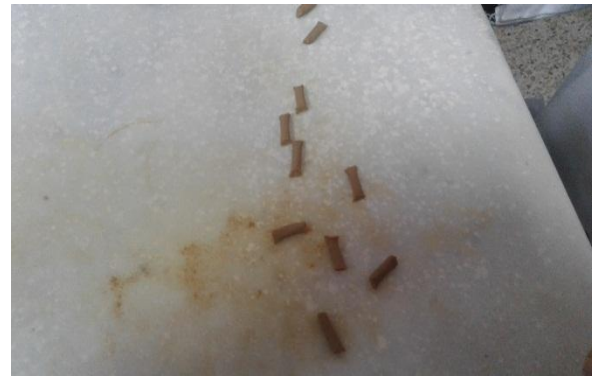
Photo N°(9): Détermination de la limite de liquidité.
