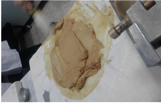
Photo N°(8): Détermination de la limite de liquidité.
