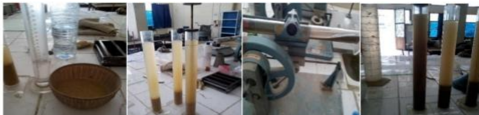
Figure N° 18: Principes d'essai équivalent de sable[62]
