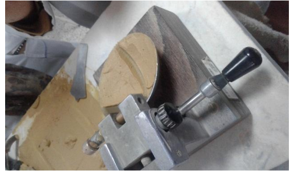
Photo N°(8): Détermination de la limite de liquidité.
