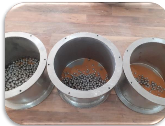
Photo III.1.3 : cylindre de l'appareil MDE avec le sable de dune avant broyage
