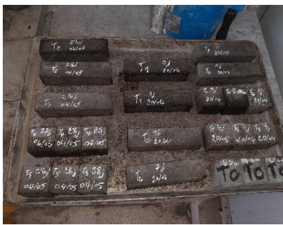
Photo.IV.2.a : échantillons de mortier
