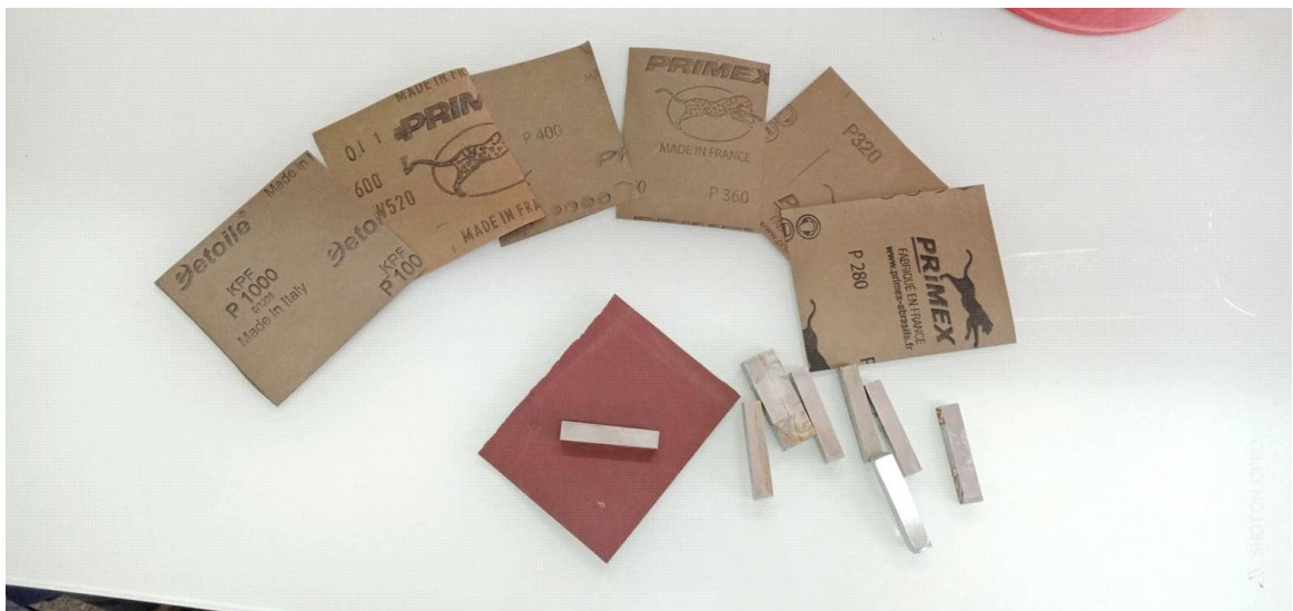
Figure III-3 L'opération de polissage avec du papier abrasif de différentes granulométries
