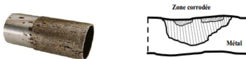
Figure I-8: Corrosion par piques
