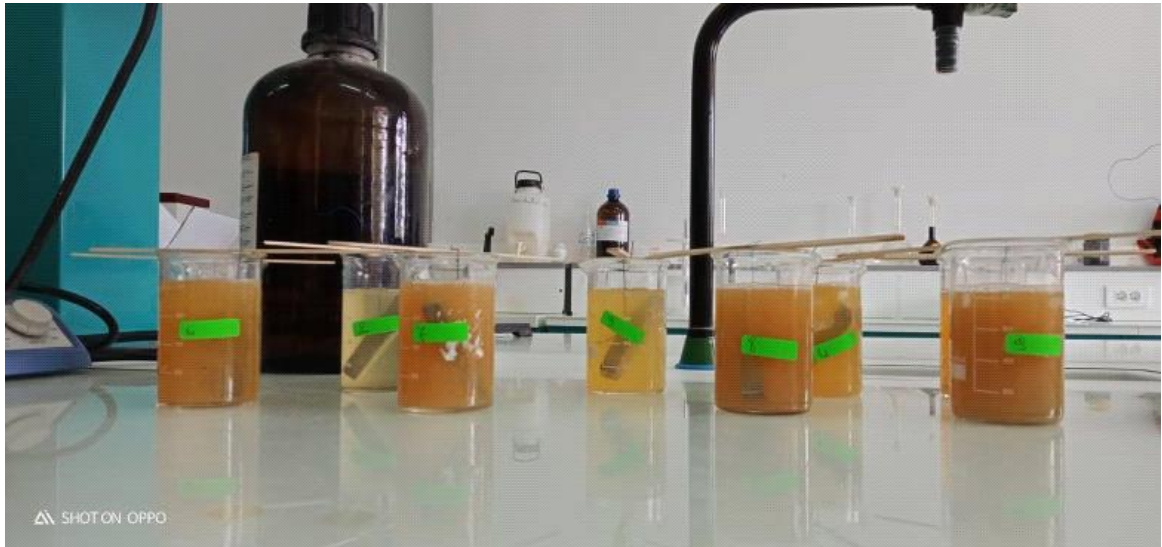
Figure N° III -9: échantillons de l'acier X70 immergés dans une solution corrosive
