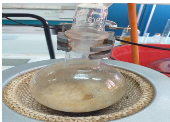
Figure 42: Dispositif de chauffage à reflux utilisé pour la synthèse d'un savon.
