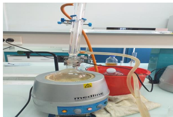
Figure 42: Dispositif de chauffage à reflux utilisé pour la synthèse d'un savon.
