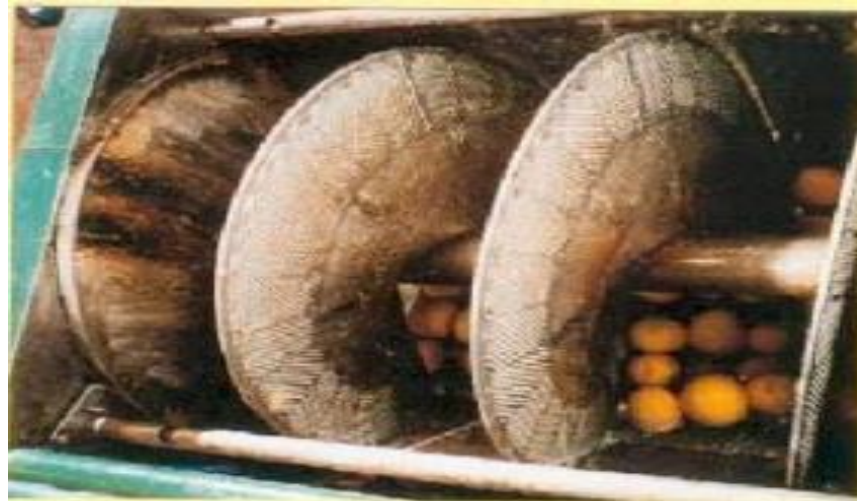
Figure 8 : Dispositif de l'extraction par expression à froid [SW6]
