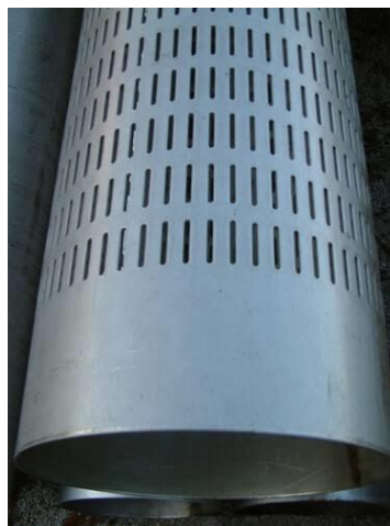
Figure 58. Photo d'une crépine (tirée du site www.Puits-et-Forages.com )
