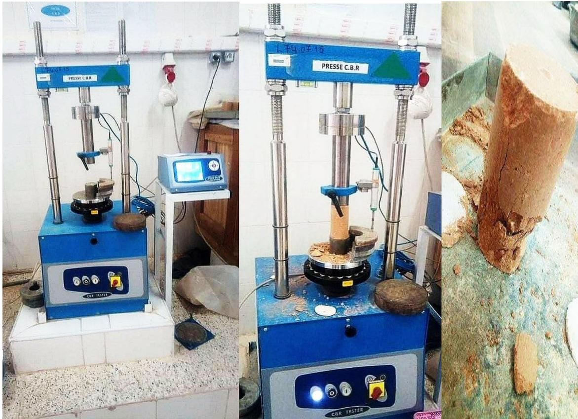
**Figure 3:23 :** Photos d'échantillons de mélange B8% testés par un essai de résistance à la compression non confinée.
