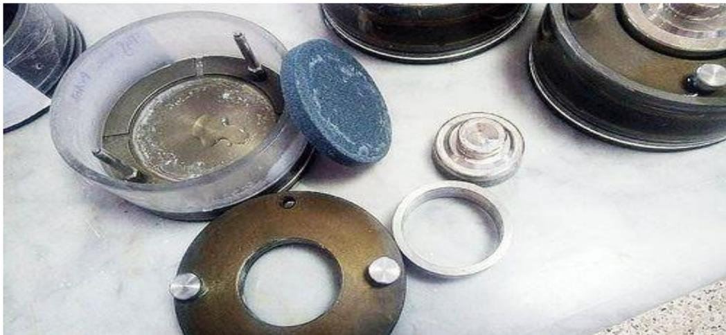
**Figure 2:24:** La cellule œdométrique.
