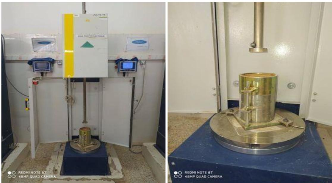
**Figure 2:5:** Moule Proctor Normal avec la dame.
