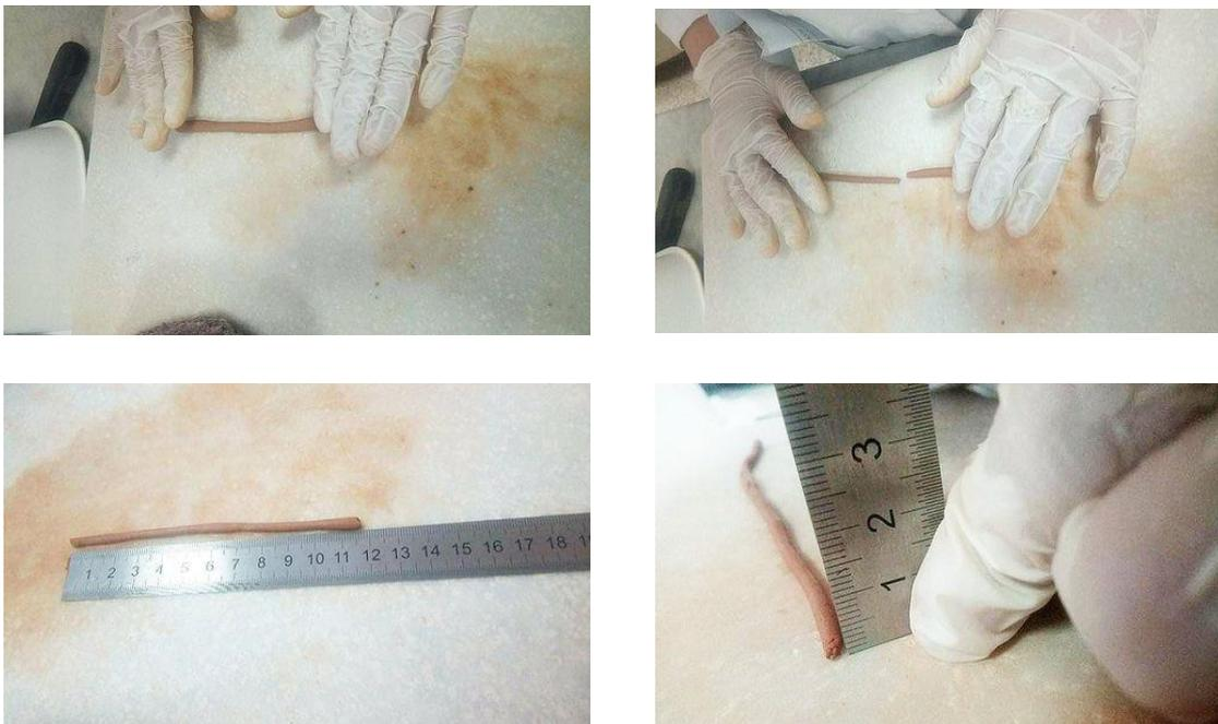
**Figure 2:10:** Essai de limite de plasticité.
