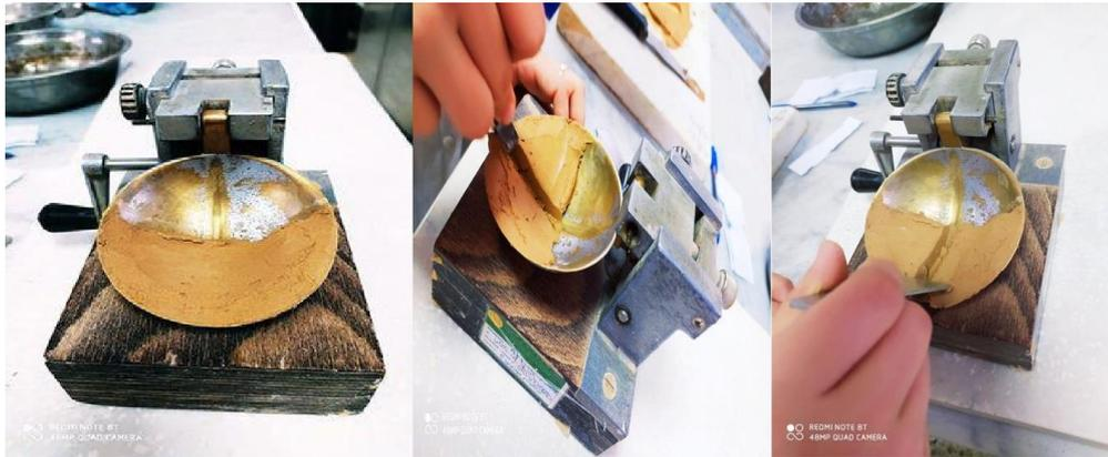
**Figure 2:9:** Boîte de Casagrande (limite de liquidité).
