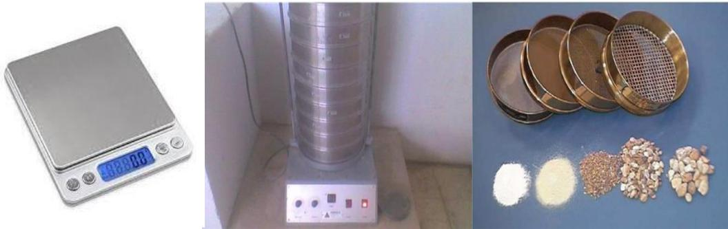
Figure 2:3 : matériel d’essai Analyses granulométriques.
