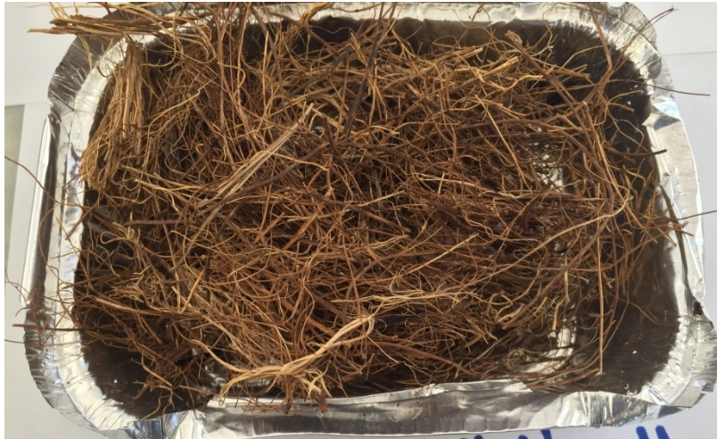
Figure III.10- Fibre traité à 80+ 0.5% de NaOH.
