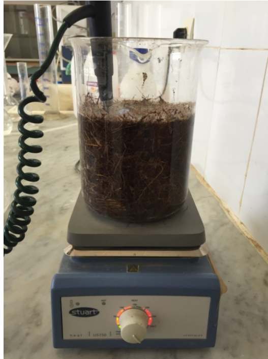
Figure III.6 - Ebullition la fibre dans un récipient.
