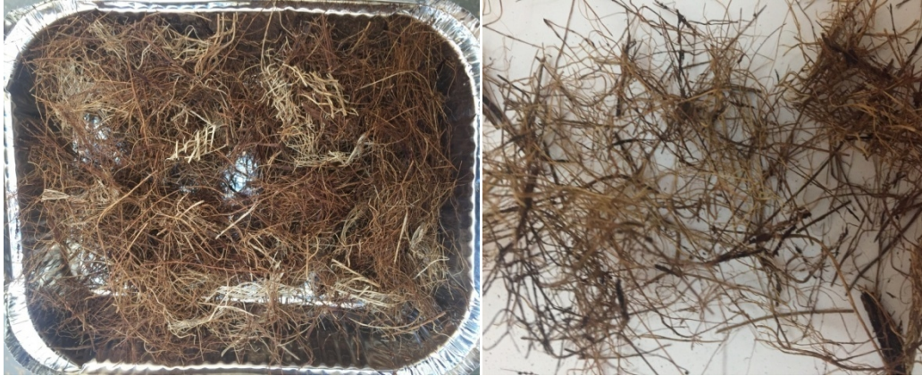
Figure III.8- Fibre après le traitement à 80°C.
