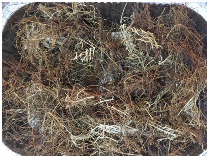
Figure III.7 – Fibre après le traitement à l'eau chaud 100°C.
