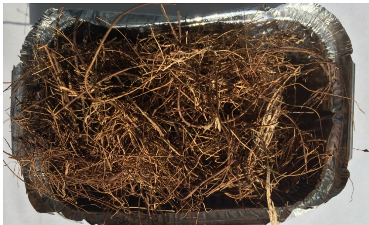
Figure III.9- Traitement à 80°C + 1% NaOH.
