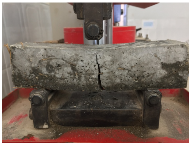
Figure III.11- Eprouvettes prismatique 4x4x16 cm 3 .
