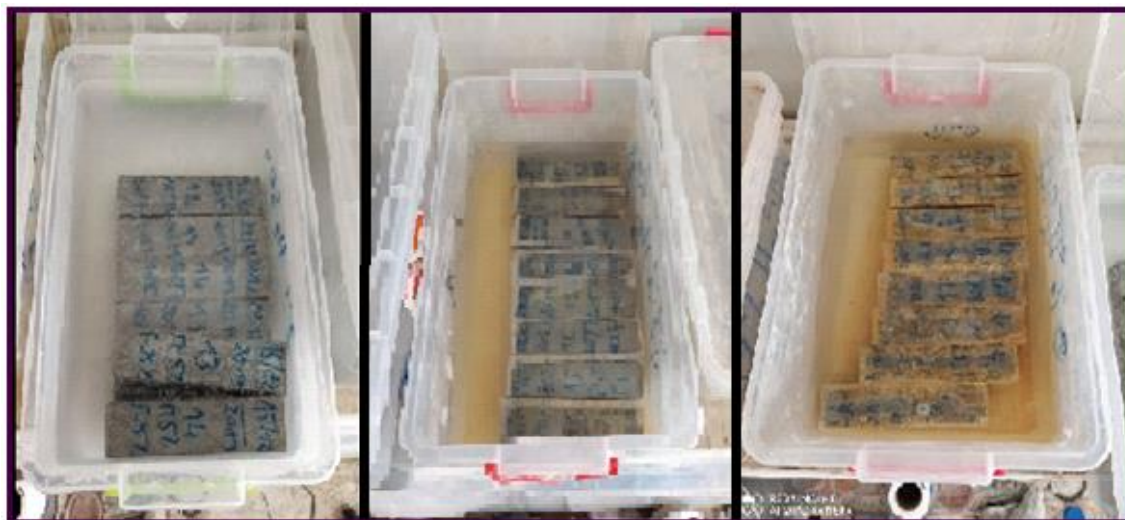
Figure (III .20) : Conservation des éprouvettes dans l'acide sulfurique et eau.
