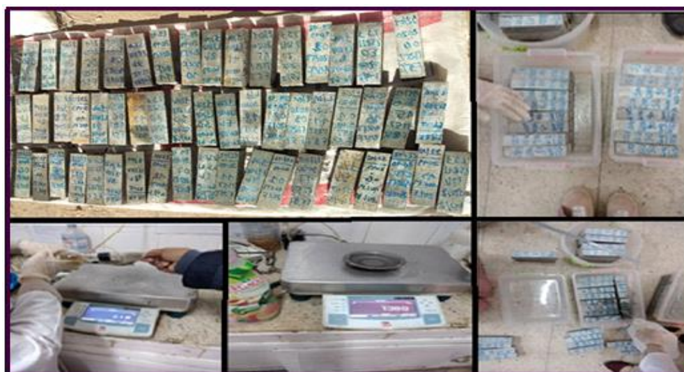
Figure (III .18) : Préparation de conservation des éprouvettes et l'attaques chimiques.
