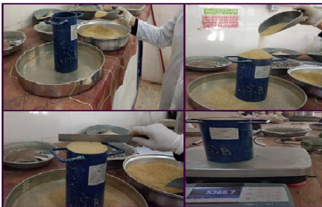
Figure (III.9) : processus de l'essai de la masse volumique apparente.
