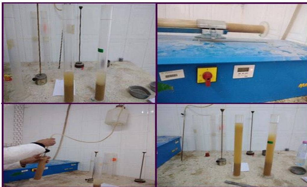
Figure (III.7) : processus de l'essai d'équivalent de sable
