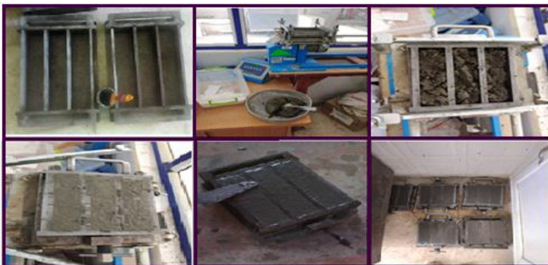
Figure (III.15) : les étapes de moulage des éprouvant
