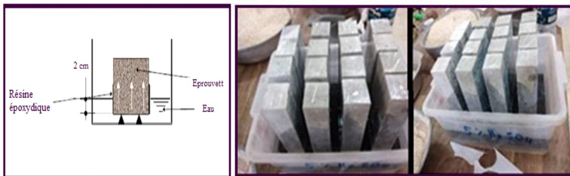
Figure (III.27) : Essai d'absorption par capillarité
