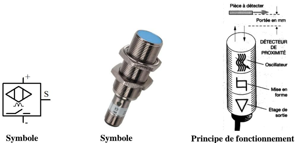
Figure 2-41 : Capteur de proximité inductif TOR,
