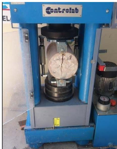
**Figure I. 3: Essais d'écrasement en traction par fendage**
