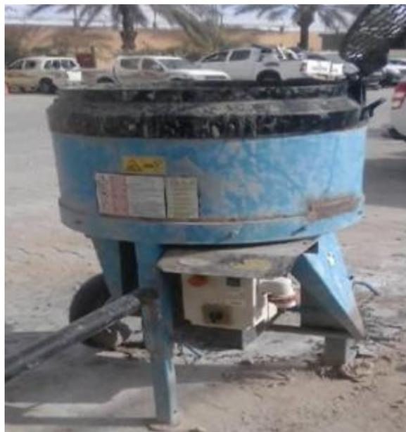
**Figure VII. 2:Le malaxeur de béton du laboratoire.**
