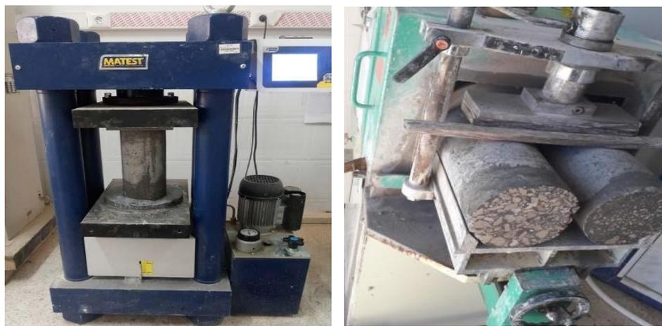
**Figure VIII. 3: Essai de compression**
