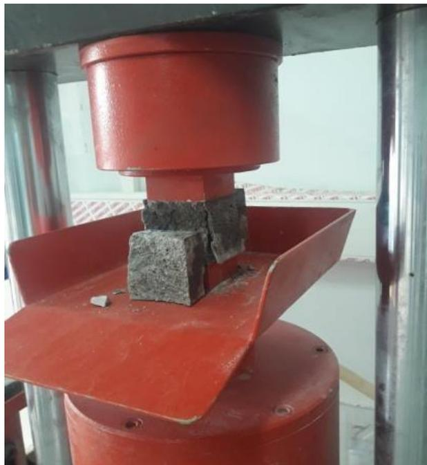
**Figure VII. 11: Dispositif de compression**
