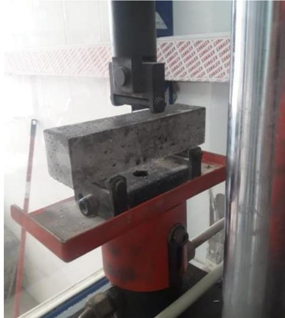
**Figure VII. 10: Dispositif de traction par flexion.**
