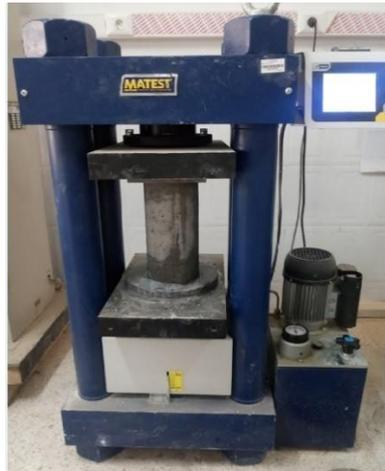
**Figure I. 2:Essais d'écrasement en compression simple**
