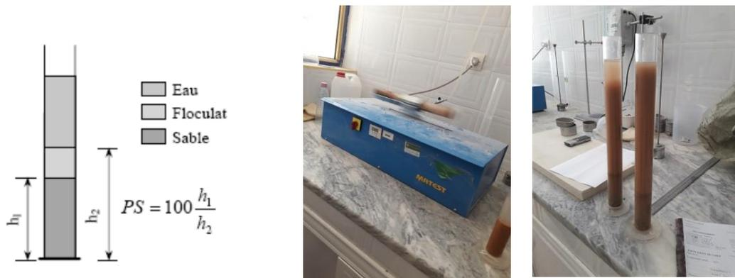
**Figure V. 7: essai de l'équivalent de sable**
