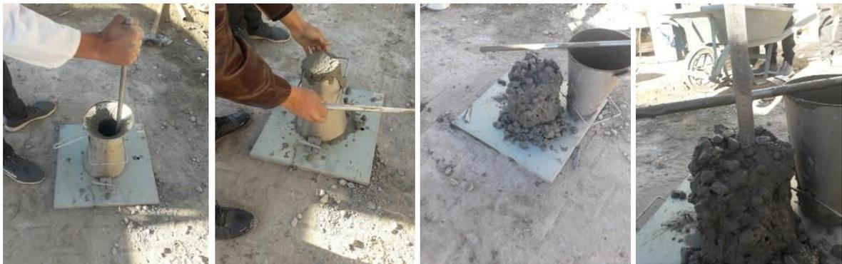
**Figure VIII. 1: essai d'affaissement du béton**
