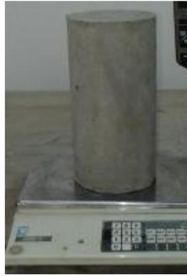
**Figure VII. 7: Mesure de la masse volumique des bétons à l'état durci.**
