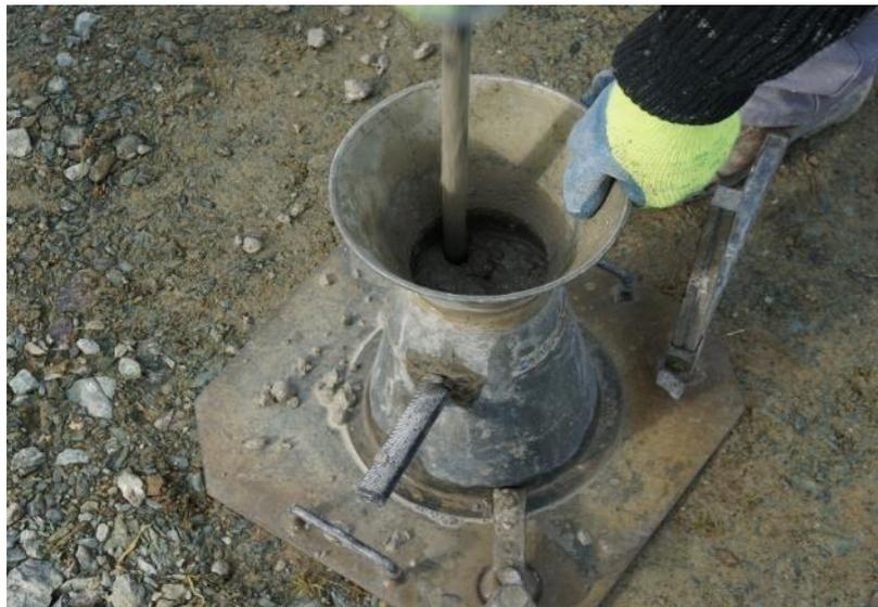
**Figure VII. 4: l'essai d'affaissement au cône d'Abrams**
