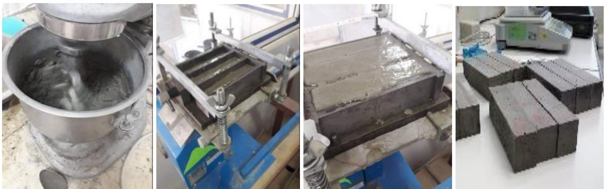
**Figure VII. 9: Confection des éprouvettes du mortier**
