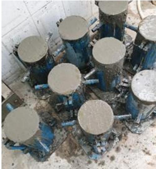
**Figure VII. 3: Confection des éprouvettes du béton**
