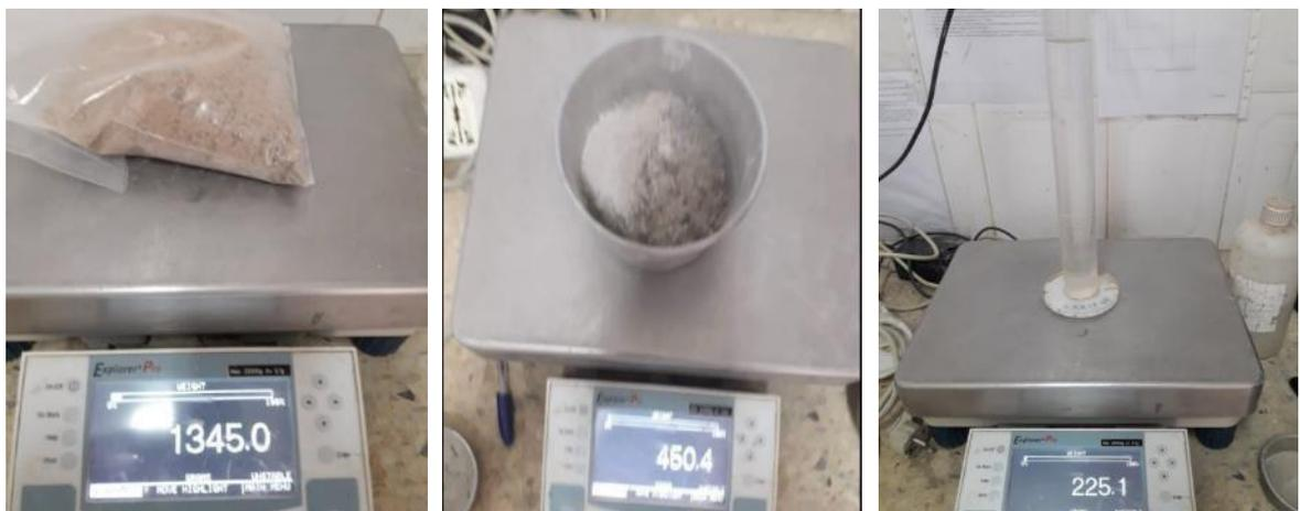
**Figure VII. 8: Pesage des composants du mortier**
