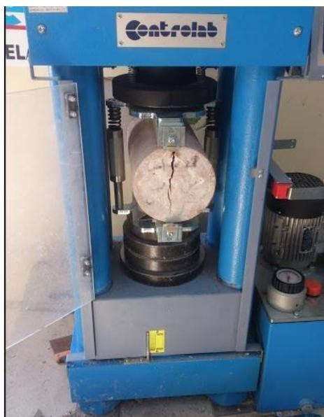
**Figure VII. 6: Essai de traction par fendage**
