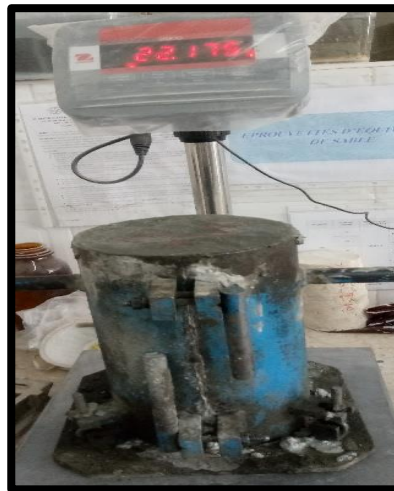
Figure (IV.13): La masse volumique du béton frais.
