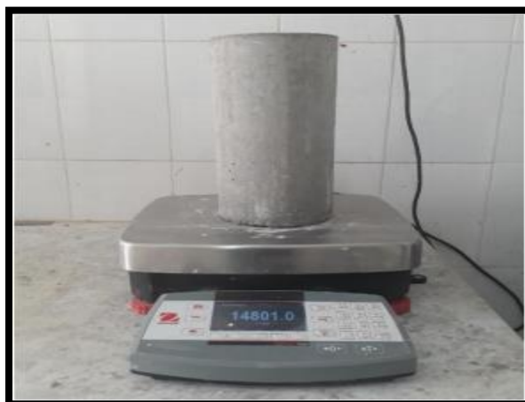
Figure (IV.19): La masse volumique du béton durci.
