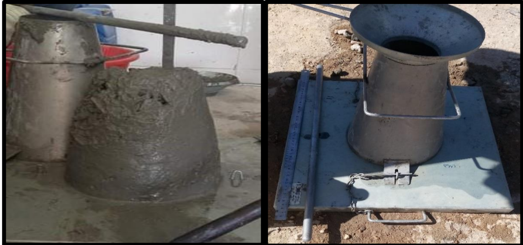
Figure (IV.11): Essai d'affaissement cône d'Abrams.
