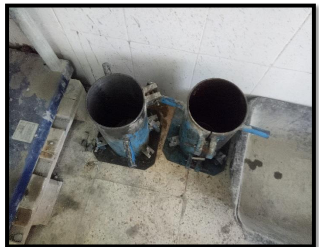
Photo 4 : Moules d'éprouvettes de béton
