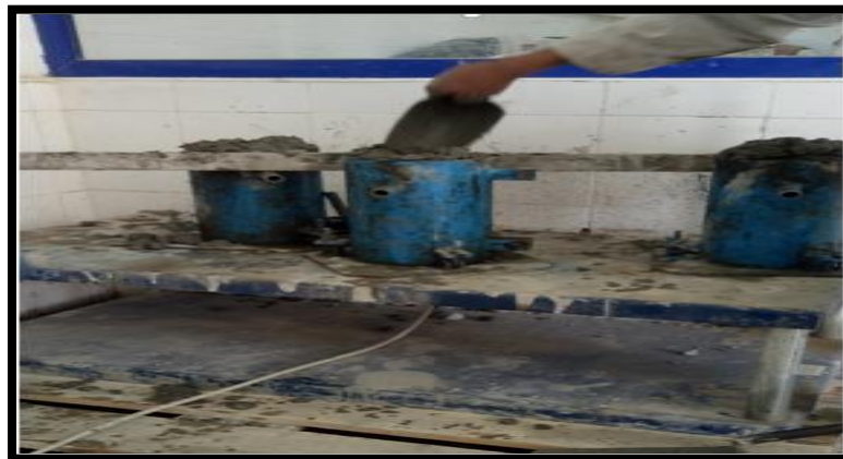
Figure (IV.14): remplissage des moules.
