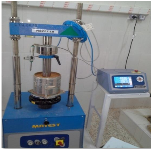
Photo II-9 : Presse CBR pour poinçonnement et écrasement Des éprouvettes de compression simple
