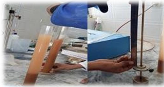
Figure III- 3. Essai de l'équivalent de sable.
