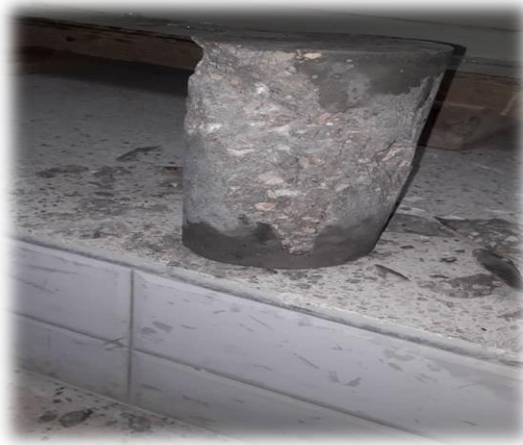
Figure III- 18. Des éprouvettes après essais de compression
