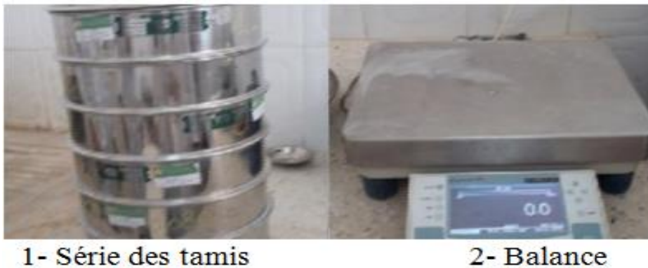
Figure III- 4 Equipements de l'analyse granulométrique.
