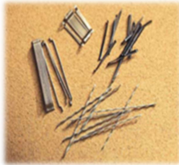
Figure I- 5. Différents types de fibres métalliques (8).
