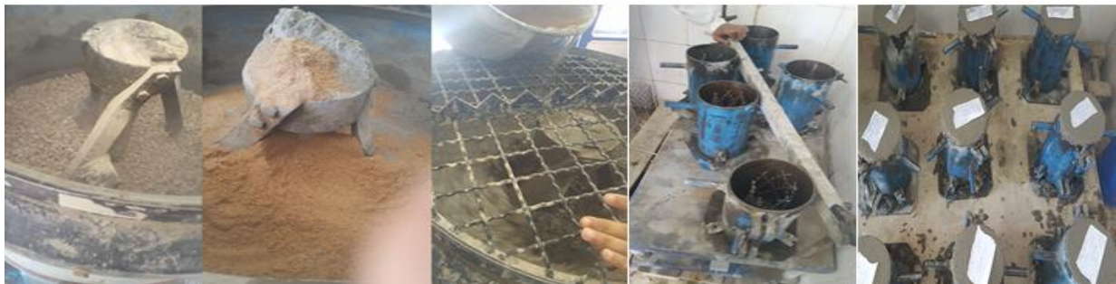
Figure III- 14. Les étapes de confection d'un béton
