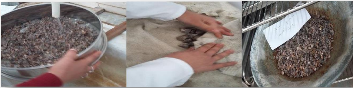
Figure III- 7. L'essai de la propreté
