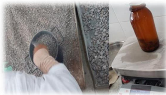
Figure III- 6. L'essai de masse volumique.
