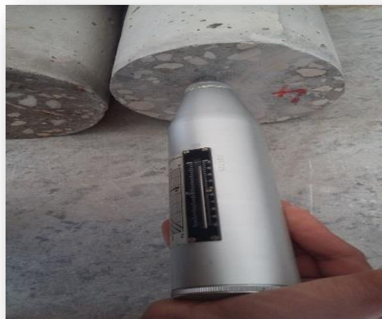
Figure III- 19. L'essai de scléromètre
