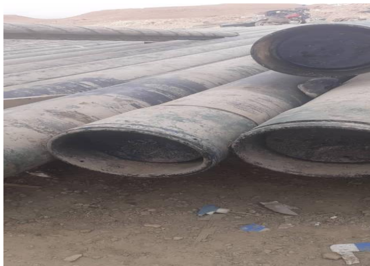
Figure 22: Les tubes de protection API 13 3/8 casing (Berriane 2020)
