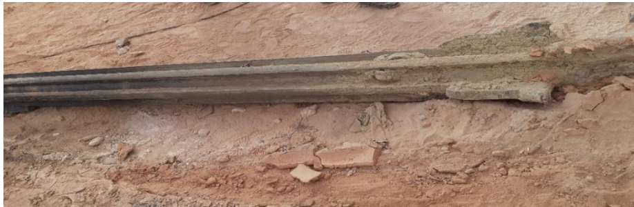
Figure 12: Outil du forage par battage (Berriane 2020)
