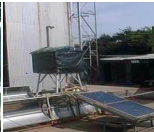
séchoir solaire de type indirect
