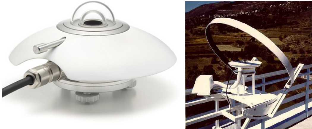
Figure II.16 : Pyranomètre pour la mesure du rayonnement global et diffus.
