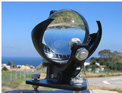
Figure II.17 : Héliographe pour la mesure de l'insolation.
