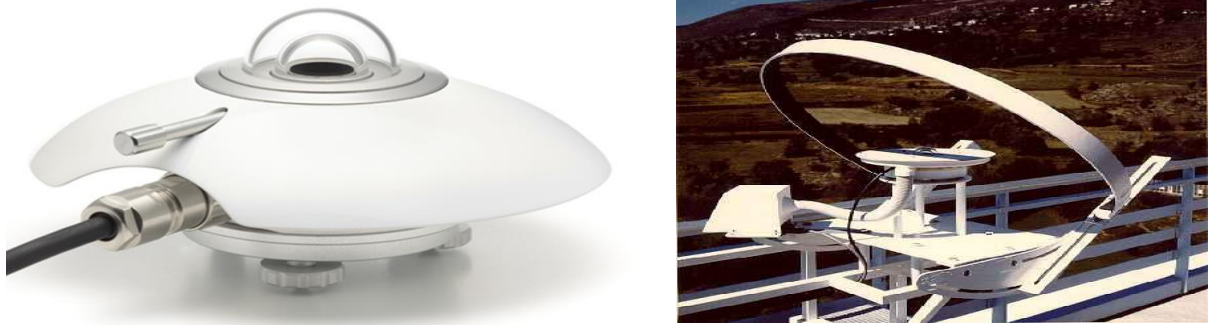
Figure I. 9 : pyranomètre pour la mesure du rayonnement global et diffuse.
