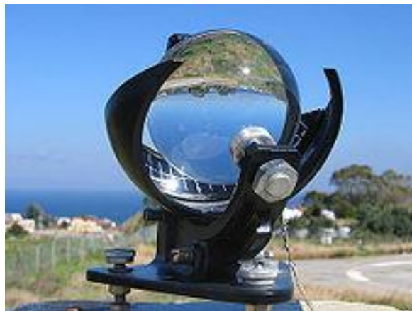
Figure I. 8 : Héliographe pour la mesure de l'insolation.
