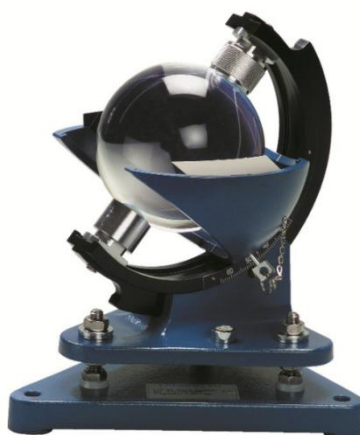
Figure I.12 : héliographe (durée d'insolation).
