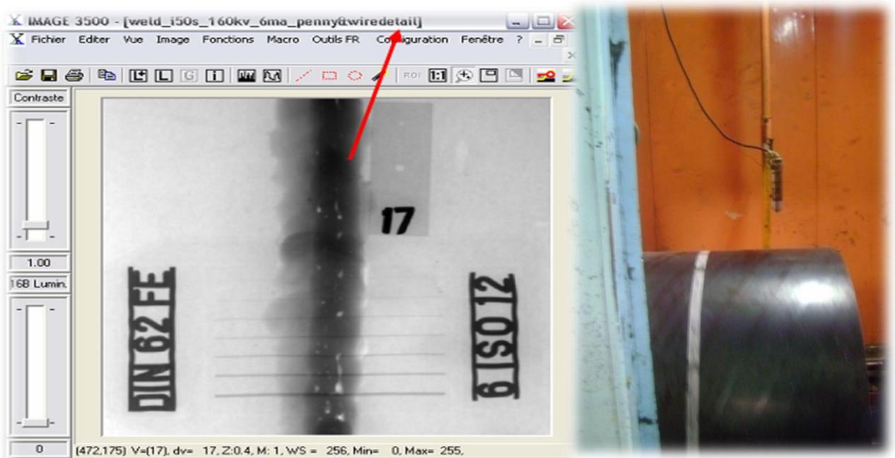
Figure 7 : contrôle radiographie
