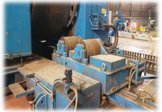
Figure 6: chariot de transport de bobine et des rouleaux presseurs supérieurs également entraînés hydrauliquement.
