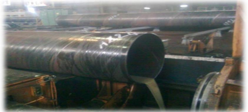
Figure 6 : contrôle hydraulique
